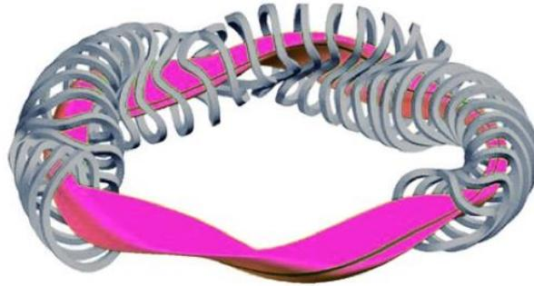
*Fig. 1.8: Configurazione magnetica Stellarator*
