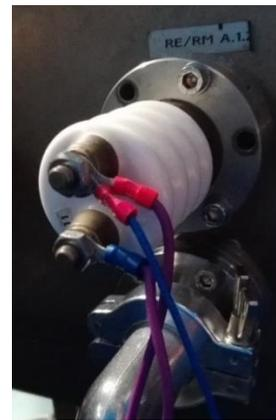
*Fig 4.2: Supporto del filamento di tungsteno*
