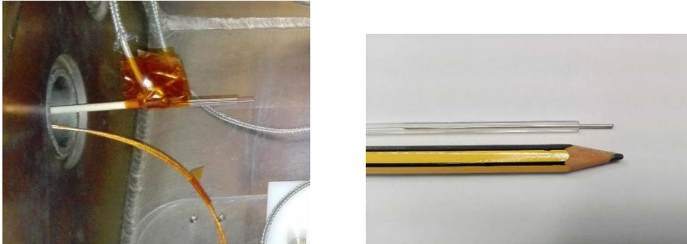
*Fig. 4.10: Sonda di Langmuir utilizzata per la caratterizzazione del plasma*
