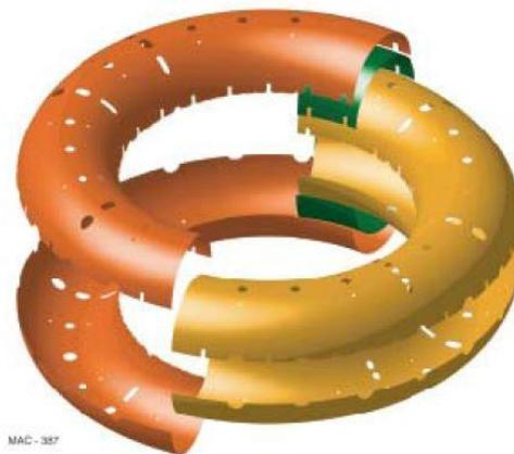
*Fig. 2.6: La scocca stabilizzatrice di RFX-mod*
