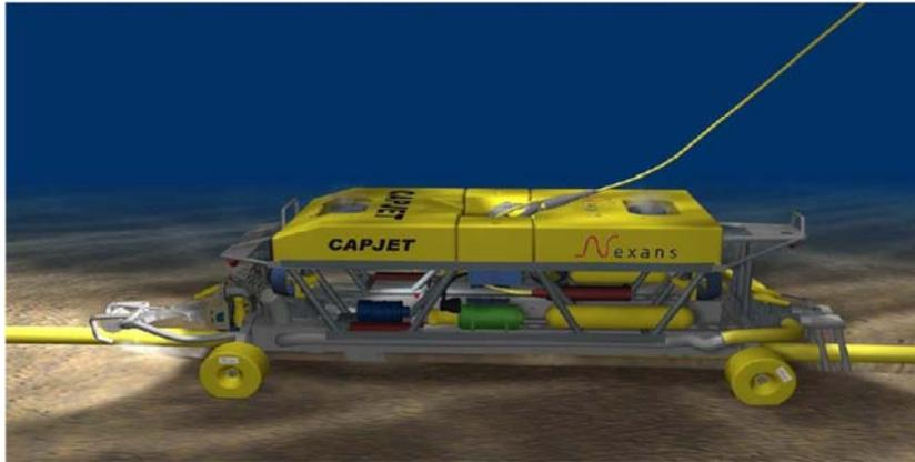
Fig. 1.3.1-3 Dispositivo ROV per interrimento tramite getto d'acqua (CAPJET)
