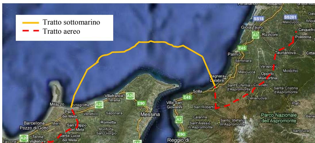
**Fig. 4.1-1** Collegamento a 380 kV Sorgente-Rizziconi
