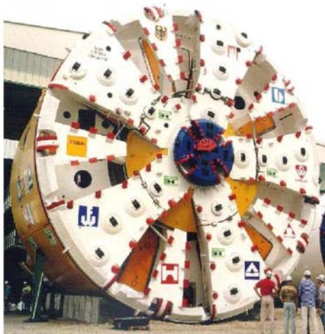
Fig. 1.3.3-3 Testa di un'alesatrice
