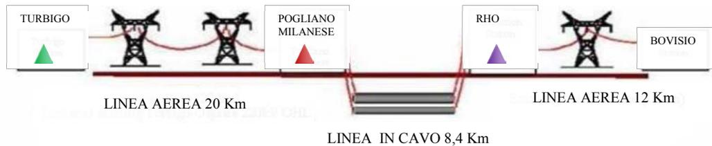
Fig. 1.3.2-5 Schema del collegamento Turbigo-Bovisio
