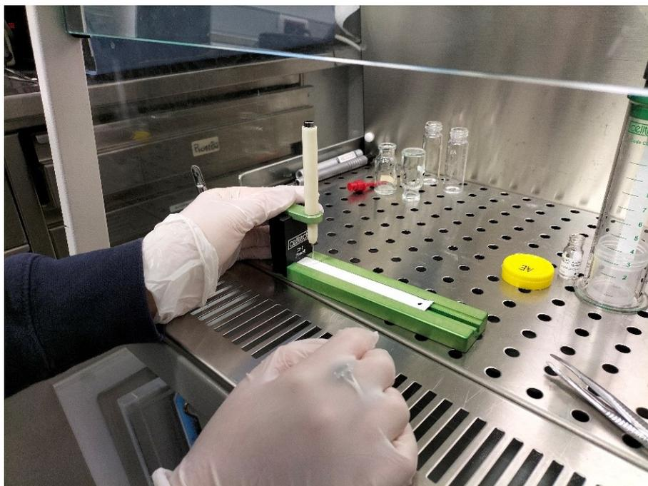
Figura 8: Posizionamento capillare in supporto.
