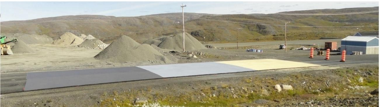
*Fig.3.7.1 Installazioni di materiali ad alto albedo nel sito test di Sallut, in Canada (Doré, Niu and Brooks, 2016)*
