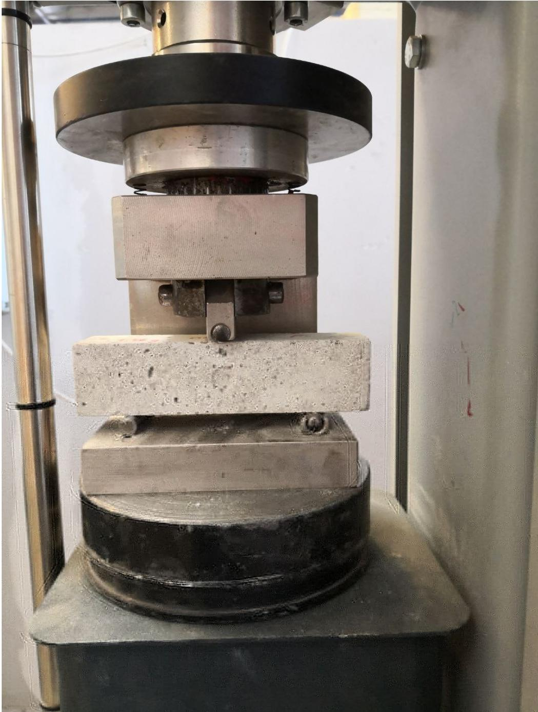
*Figura 33 Prova di flessione su provino con ausilio di compressore*
