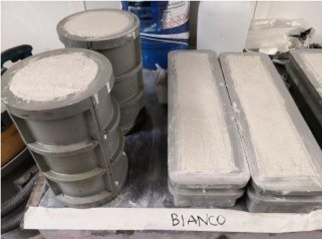
*Figura 61 Provini cilindrici e prismatici in assenza di fibre*
