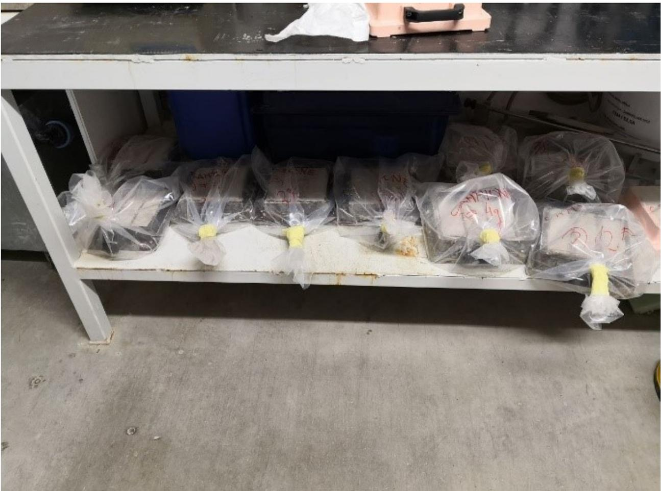
*Figura 32 Condizionamento provini in locale a temperatura e umidità controllata*
