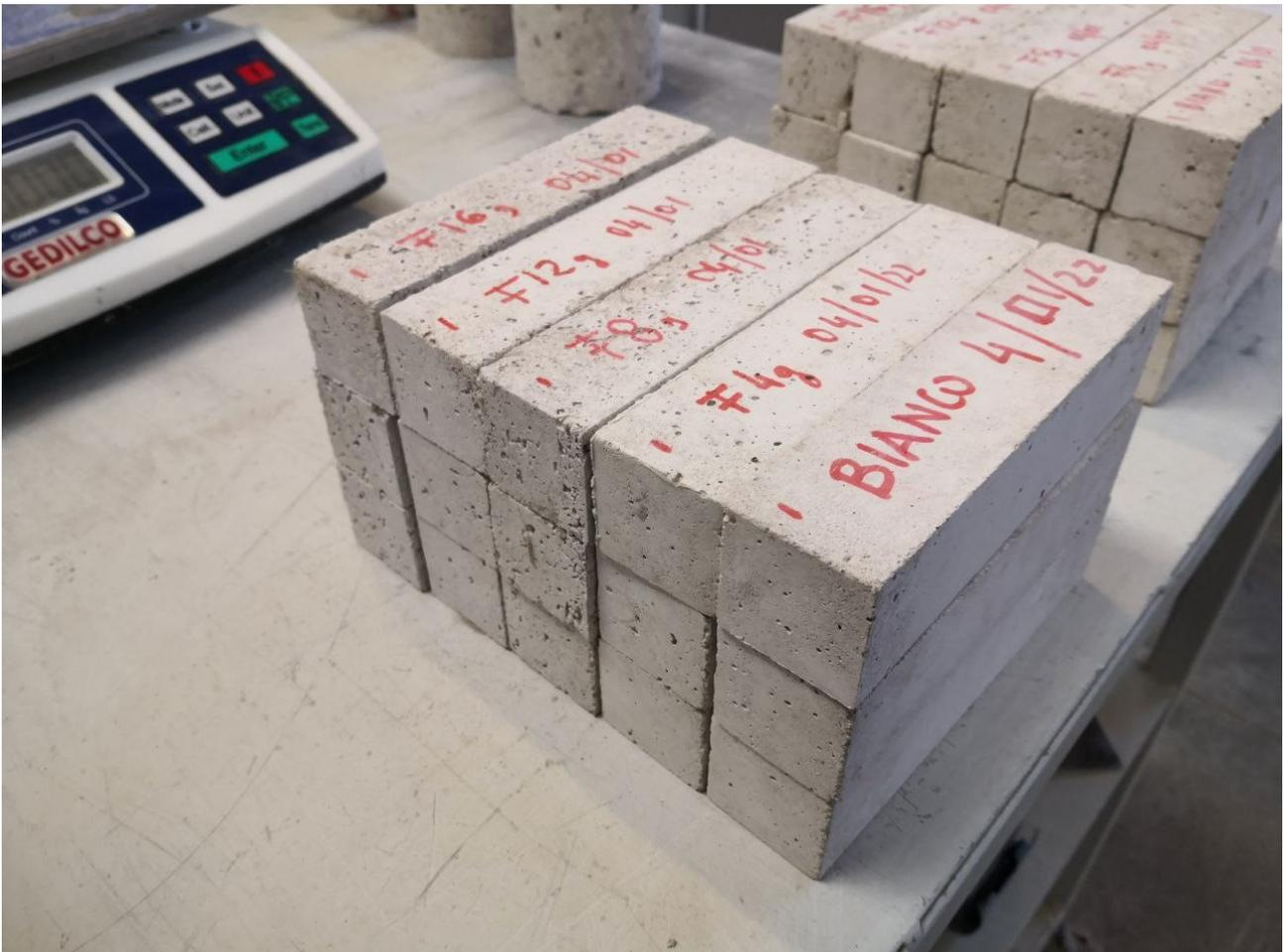
Figura 18 Provini di malta 40x40x160 mm
