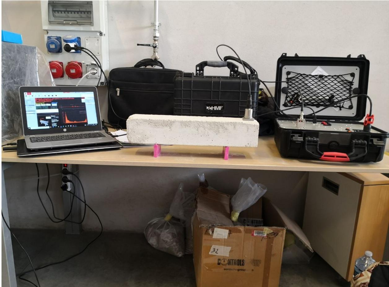
Figura 76 Esecuzione prova per determinazione modulo elastico dinamico
