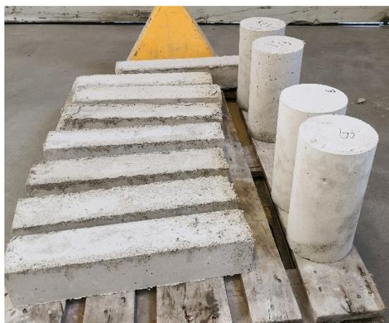
*Figura 64 Provini prismatici e cilindrici*
