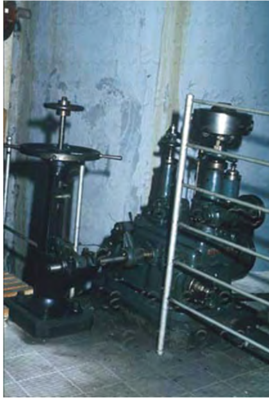
Figura 7. 5 Regolatore di velocità oleodinamico. Fonte http://www.educambiente.it/
