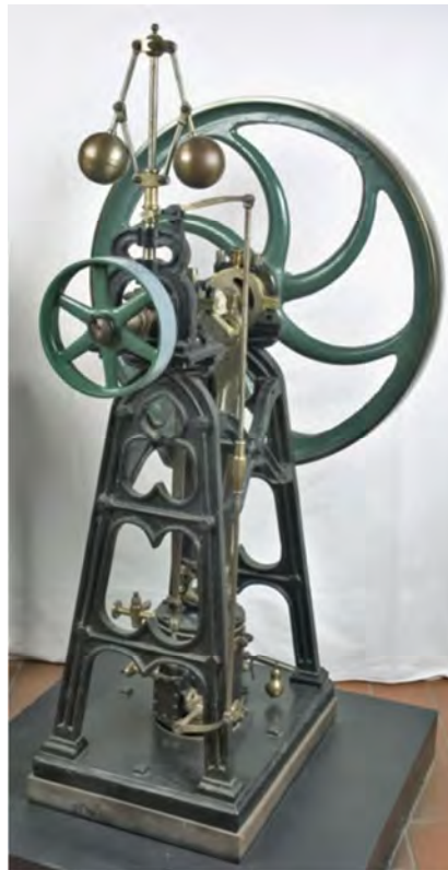
Figura 7. 6 Regolatore di velocità per turbina a vapore. Fonte http://www.museibologna.it/
