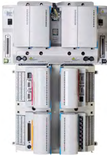
Figura 7. 15 Controllore a microprocessori Emerson Ovation per il controllo della regolazione di velocità con moduli ingresso/uscita. Fonte [4]
