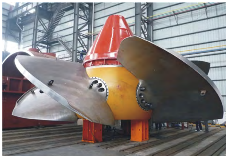
Figura 4. 12 Girante di una turbina Kaplan. Fonte sito www.tbhic.cn
