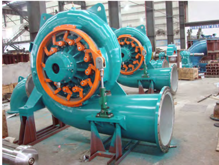
Figura 4. 8 Turbina Francis con sistema di regolazione del distributore. Fonte italian.hydropower-turbine.com
