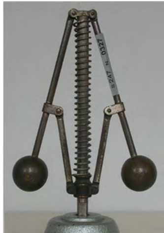
Figura 7. 3 Pendolo di Watt. Fonte www.istitutomontani.it
