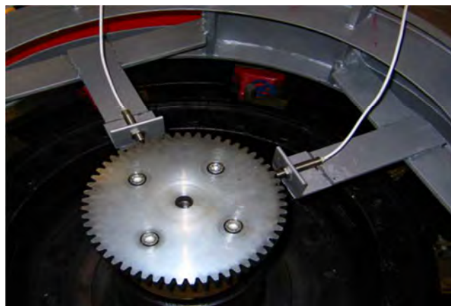
Figura 7. 10 Ruota fonica con sensori induttivi. Fonte [7]
