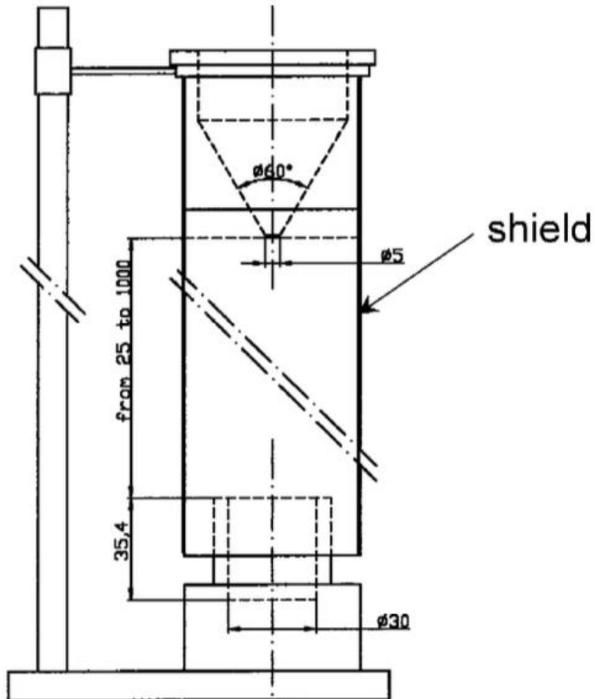
Metodo utilizzato per il calcolo della densità areata, tale metodo si è dimostrato avere delle problematiche per la misurazione in determinate condizioni e si è proposta una configurazione innovativa.
