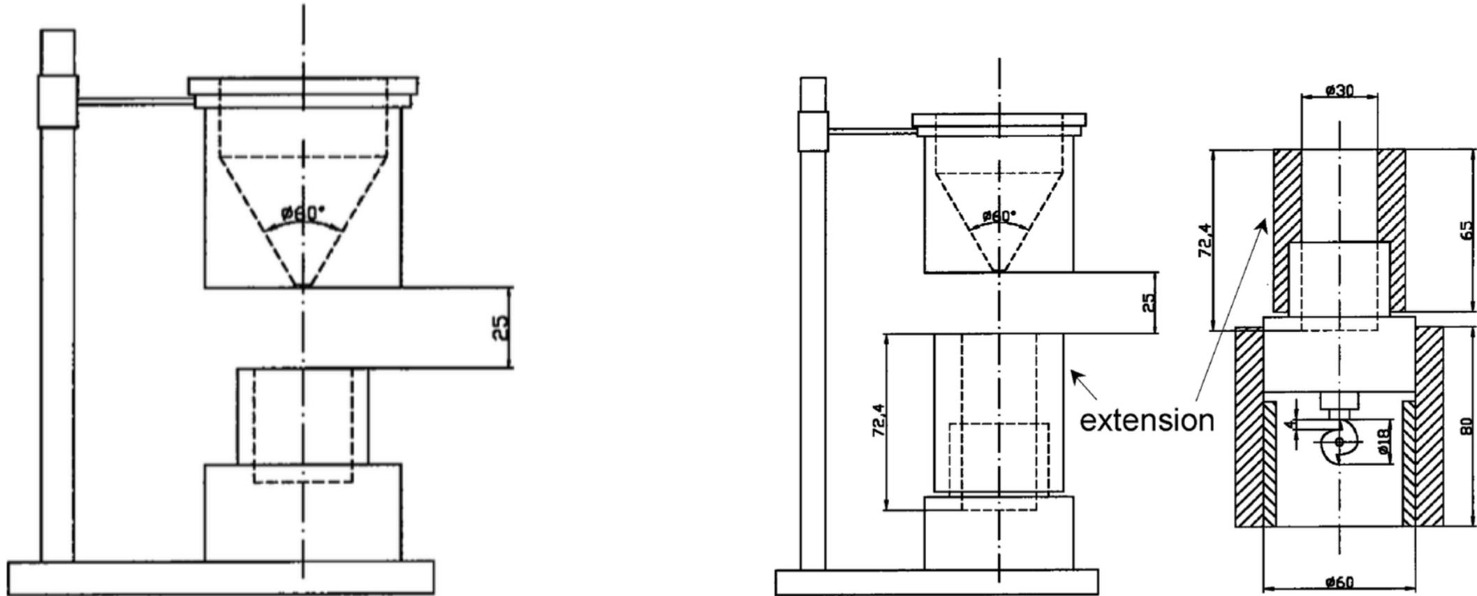
Apparecchiature per il calcolo delle densità.
