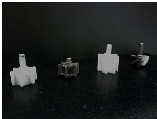
Figura 6.4. Giranti radiali e assiali, disponibili in teflon e in acciaio.
