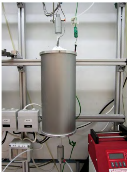
Figura 5.2. Reattore in flusso in fase gas. Tubo di quarzo interno ad un forno in fibra di ceramica in struttura cilindrica d'alluminio.
