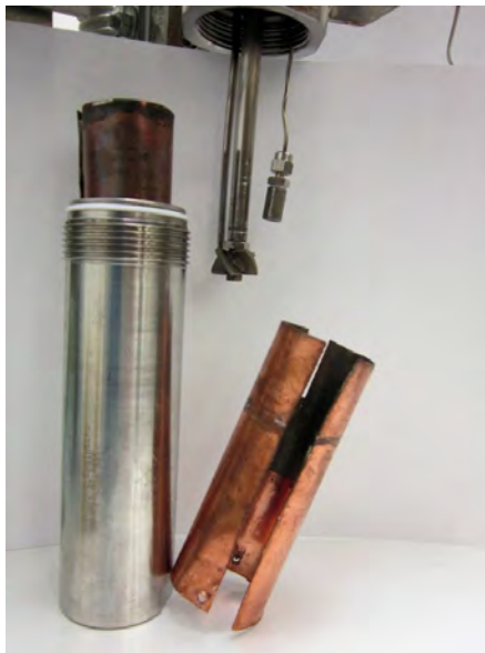
Figura 4.1. Catalizzatore di Pd su Cu, tipologia fascia, collocato esternamente al reattore batch (destra), e internamente ad esso (sinistra).
