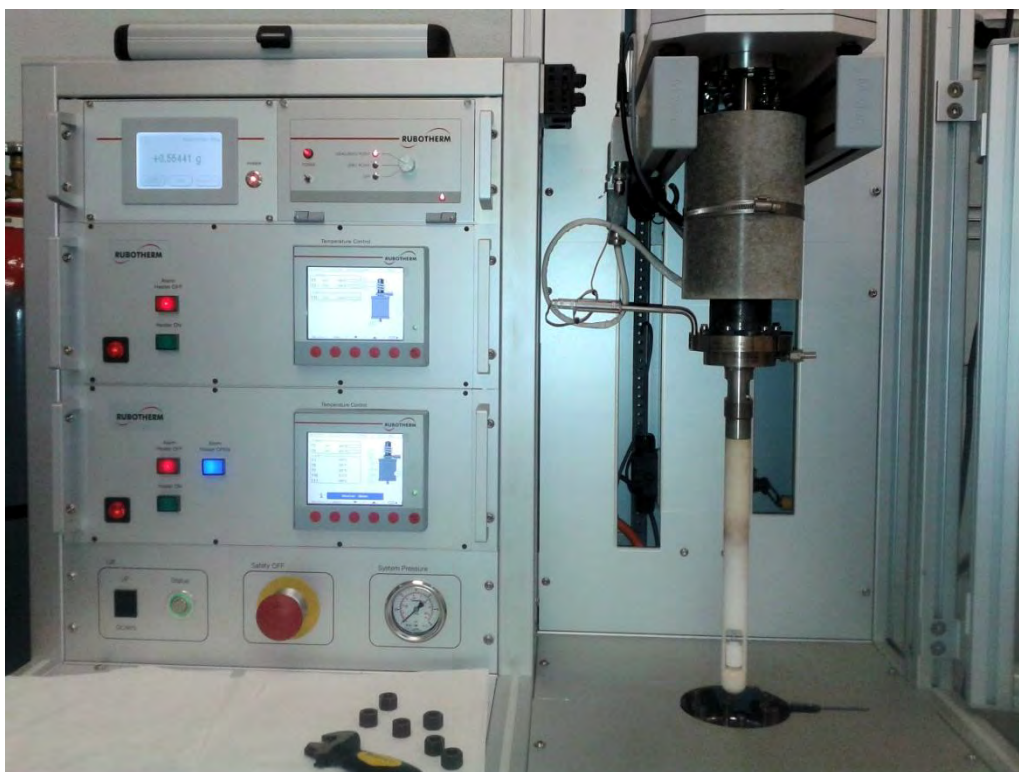
Figura 7.18 Strumento per l'analisi TGA (Thermo-Gravimetric-Analysis) in funzione durante la prova.
