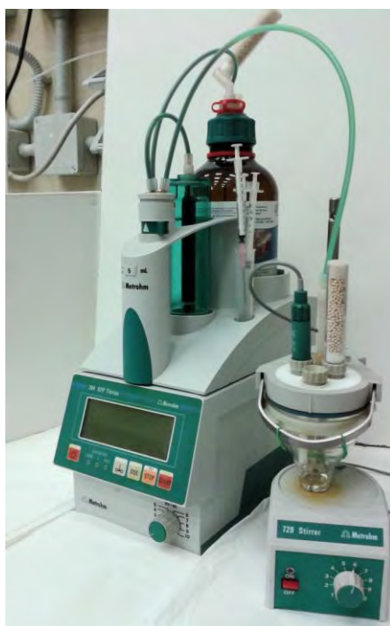
Figura 6.7. Titolatore automatico 784 KFP Titrino Metrohm Karl Fisher per l'analisi quantitativa del sottoprodotto di reazione acqua.
