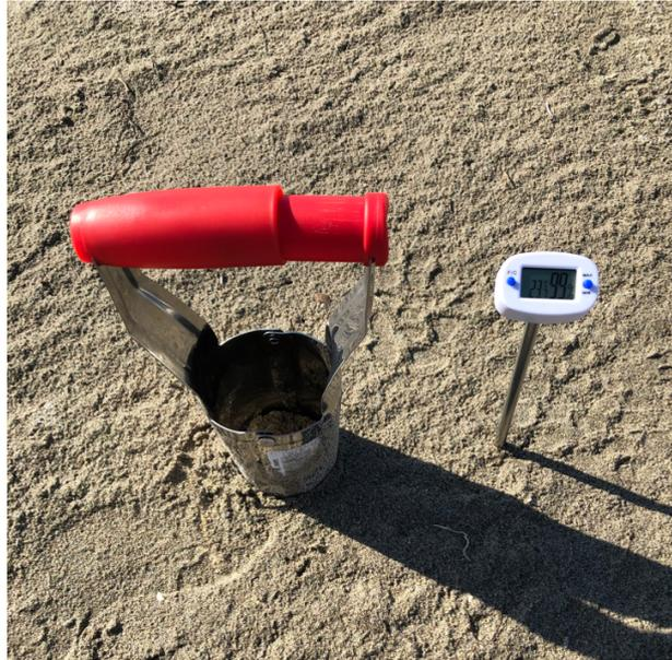
*Figura 19. Pianta bulbi: strumento utilizzato per prelevare campioni di suolo.*
