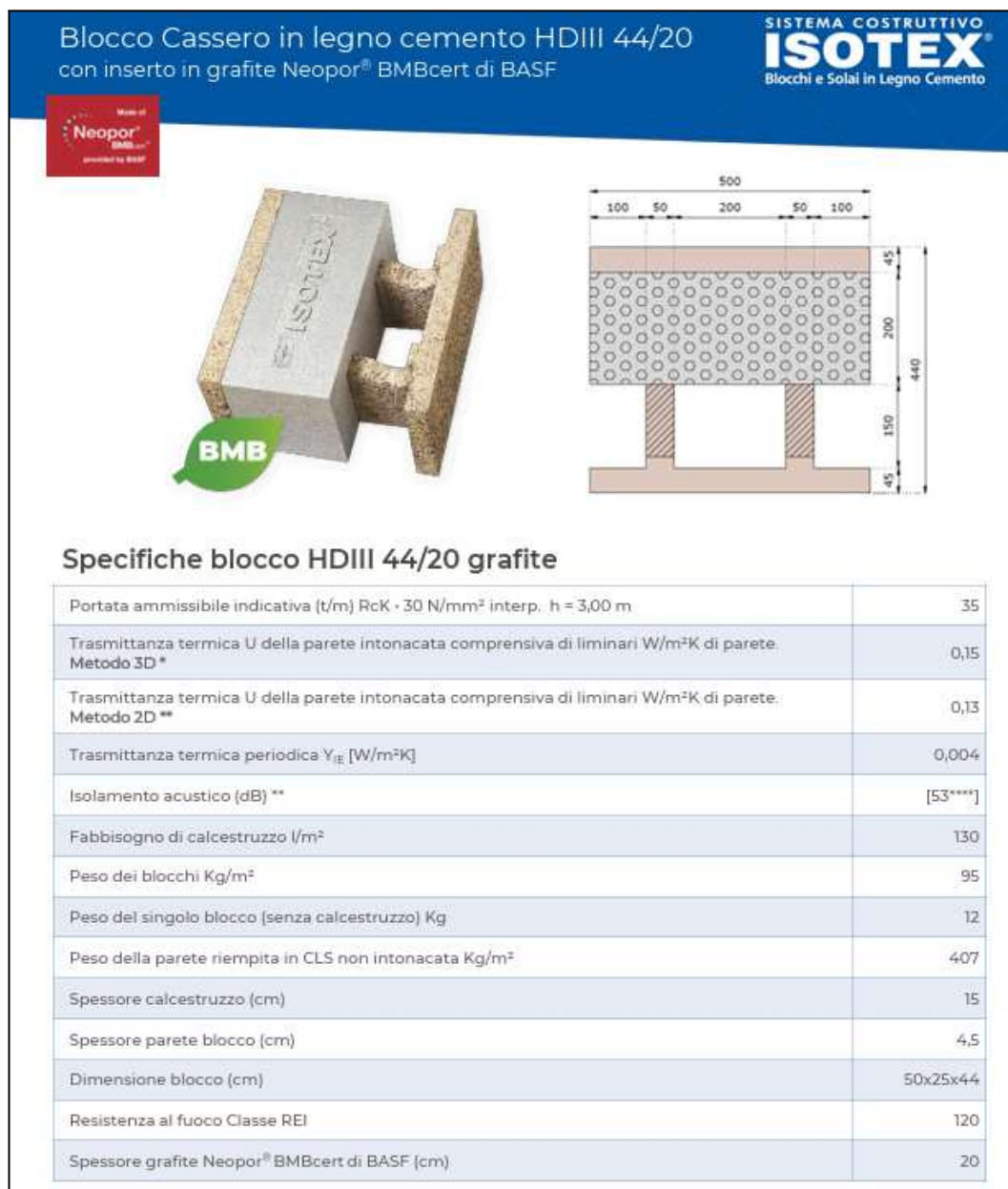
Figura 16: Scheda tecnica blocco HDIII 44/20
