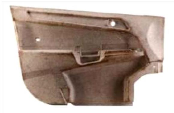
Figura 6.19 – Pannello per sportello realizzato in Fibrit.
