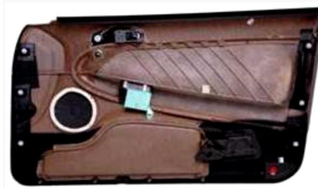
Figura 6.23 – Pannello per sportello realizzato in Wood-Stock.
