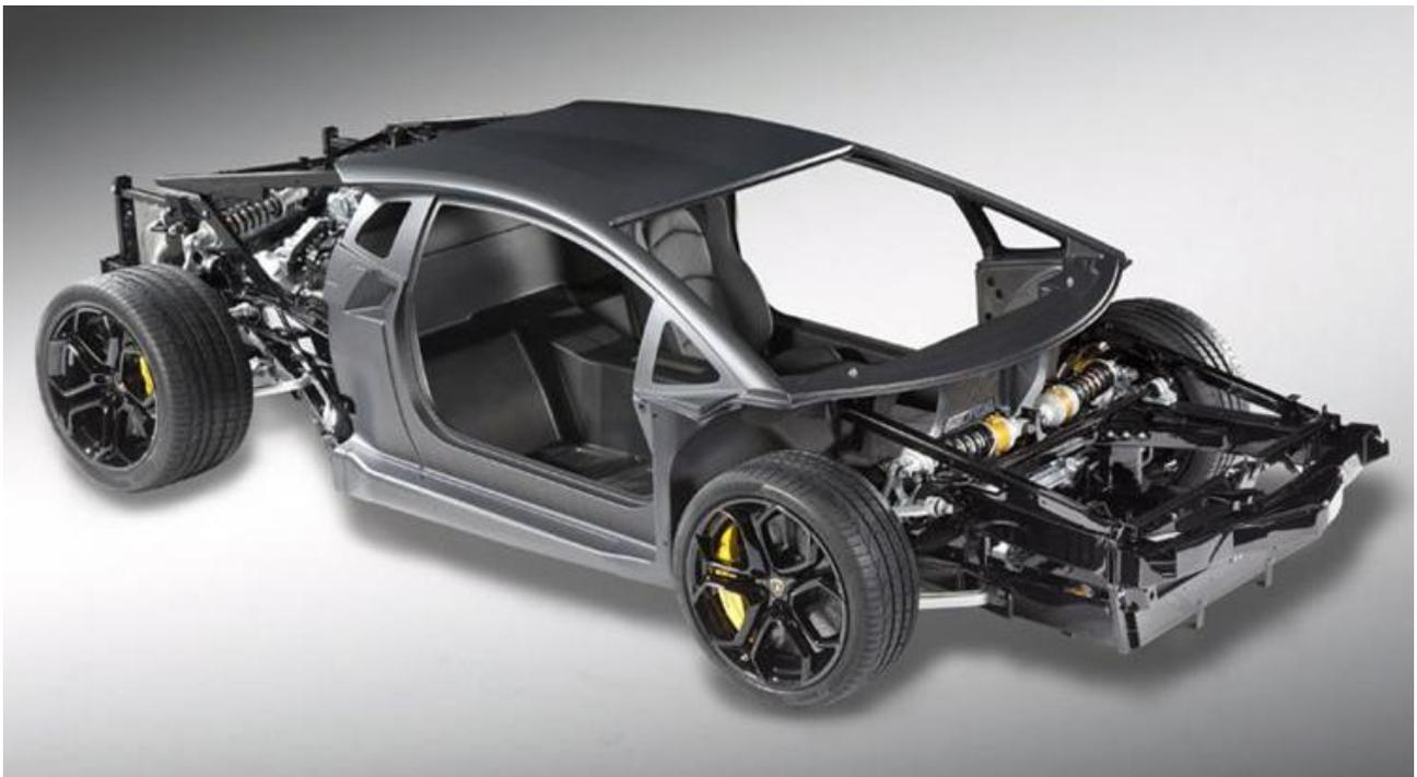
Figura 5.5 – Telaio della Lamborghini Aventador LP 700-4.
