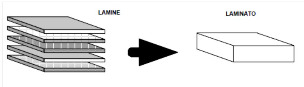
Figura 1.3 – Schema formazione di un laminato.
