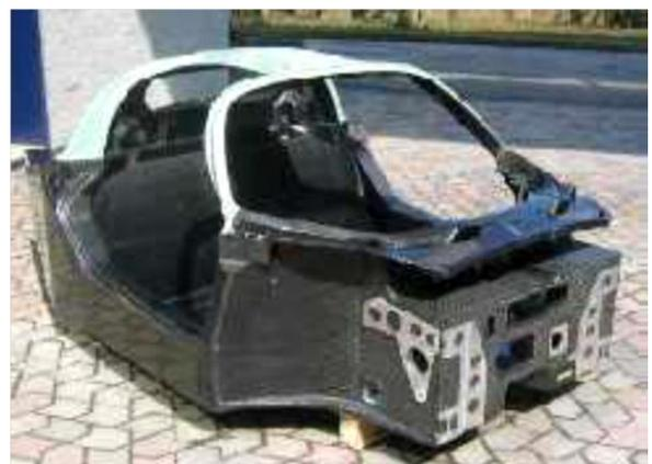
Figura 1.5 – Telaio realizzato con sandwich in fibre di carbonio e honeycomb in schiuma di alluminio
