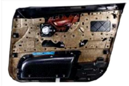
Figura 6.20 - Pannello realizzato con fibre naturali e resina epossidica.
