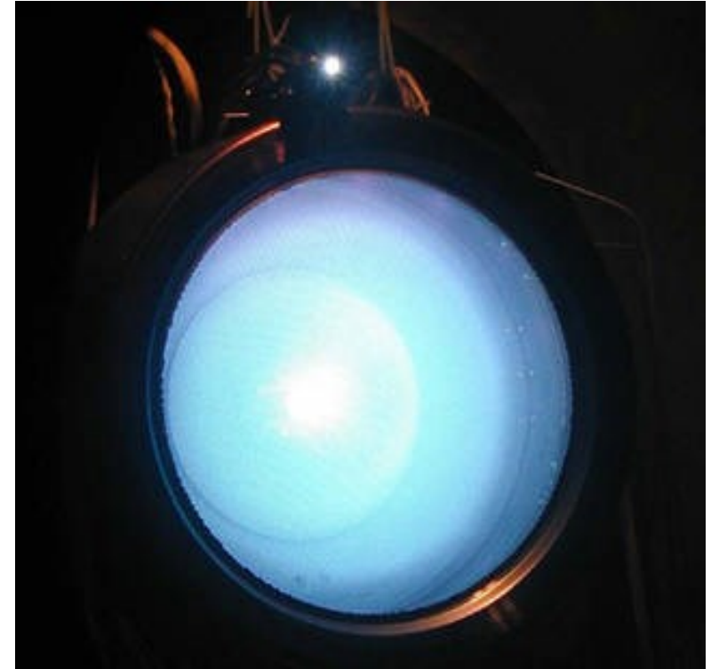
Figura 3: Propulsore ionico Evolutionary Xenon Thruster (NEXT) della NASA in funzione.
