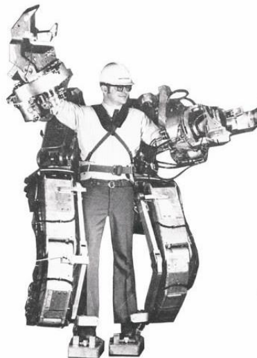
Figura 1.3. Esoscheletro Hardiman , un progetto nato nella metà del 900[1]
