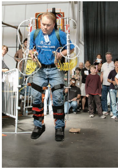
Figura 1.4. Esoscheletro Lifesuit , un prototipo che permise di far tornare a camminare un paraplegico dopo 20 anni[1]
