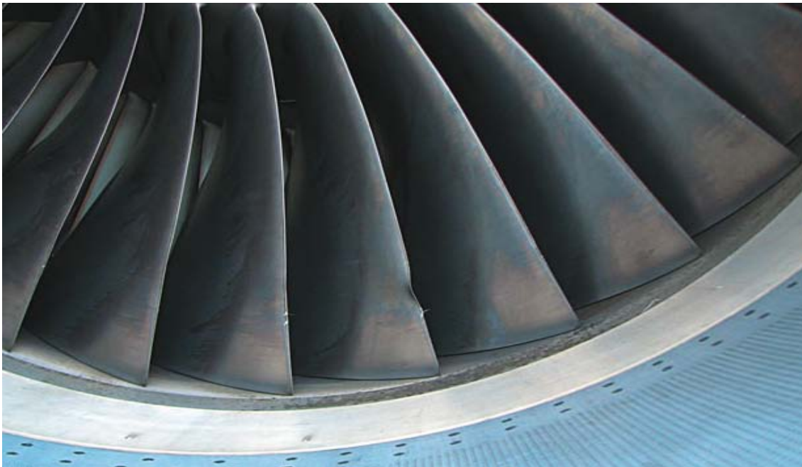
Figura 4.56: Comparazione tra danni reali di una turbina e la deformata dell'analisi. Fonte: Roger Nicholson, William S. Reed, "Strategies For Prevention of Bird-Strike Events", www.boeing.com/commercial/aeromagazin
