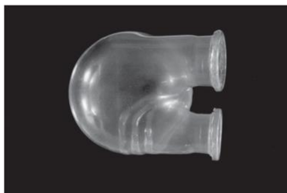
Figura 19 - Ventricolo in poliuretano di un dispositivo di assistenza ventricolare (1)
