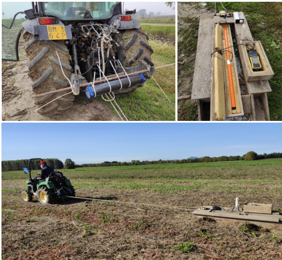
Figura 2.5: assetto strumentale adoperato in campo. In alto a sinistra: ancoraggio del rilevatore gamma al trattore, batteria a bordo; in alto a destra: CMD e antenna GPS sulla slitta di legno; in basso: assetto completo durante la raccolta dati.
