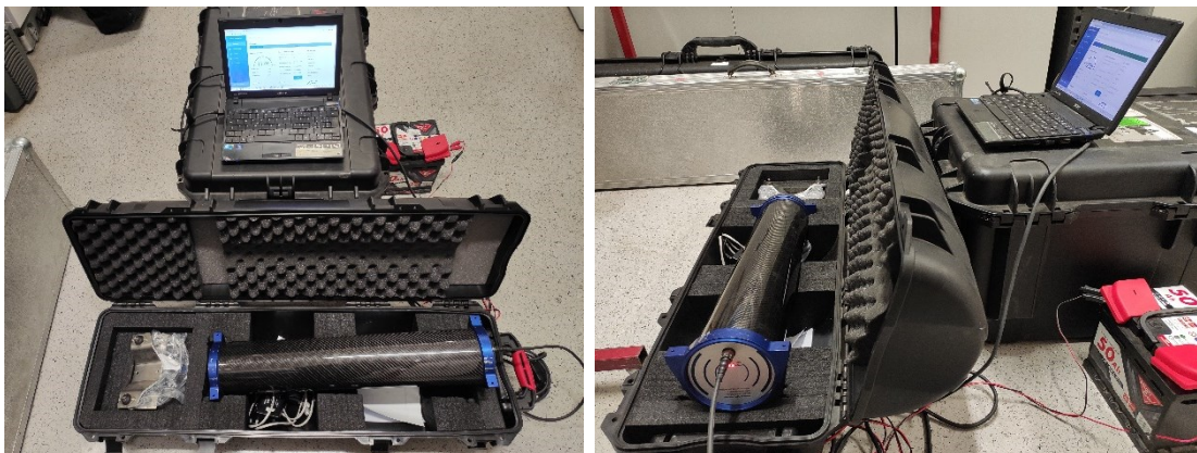
Figura 2.3: gamma-ray detector MS-2000 alimentato da batteria. Sullo schermo del computer si vede la schermata del server di mDOS.
