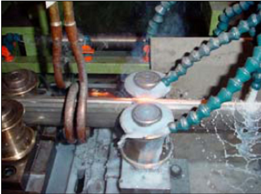
Figura 3.3: Riscaldamento, saldatura e raffreddamento del tubo
