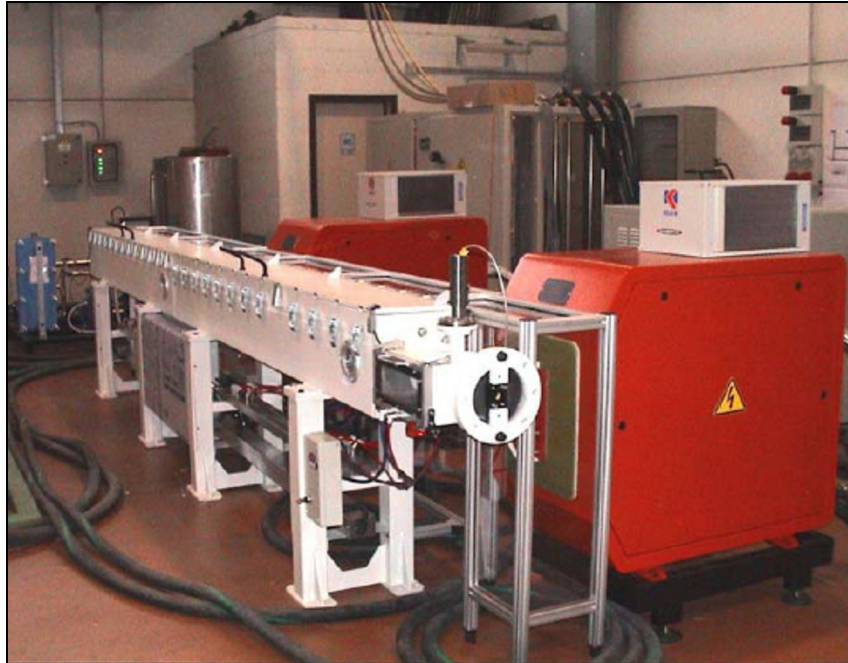
Figura 3.4: Unità di riscaldamento ad induzione
