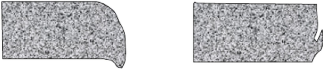
Figura 3.12: Esempi di difetti nei bordi del nastro
