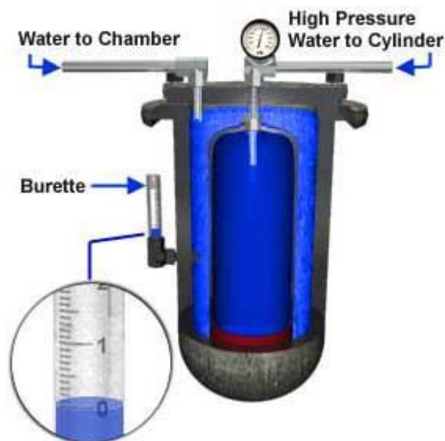
Figura 3.10: Esempio di prova idrostatica
