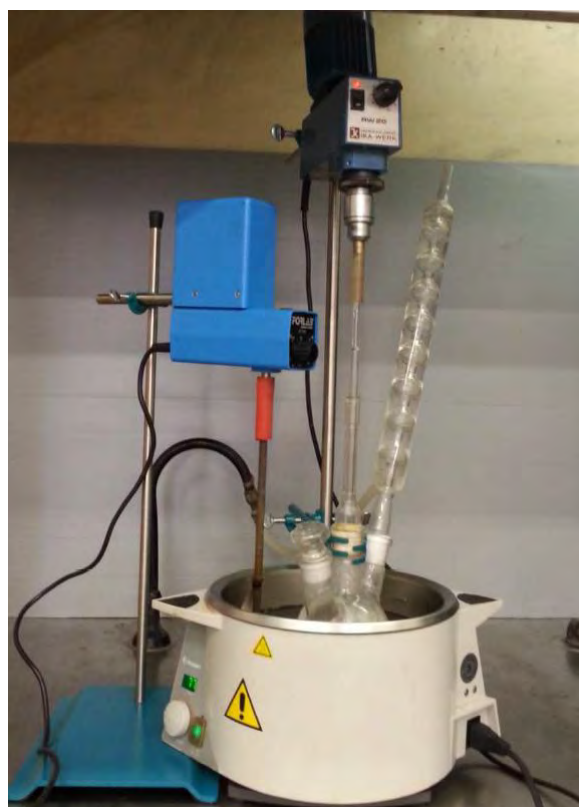
Figura 5.1. Apparecchiatura utilizzata per condurre la reazione di funzionalizzazione sul polimero in polvere
