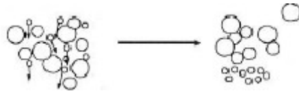
Figura 1.4. Segregazione dovuta alla percolazione (Rhodes, 2008)
