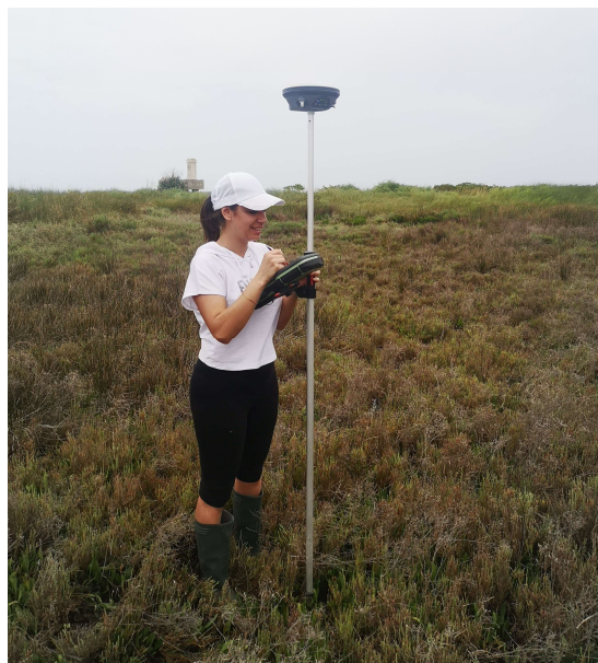
Figura 4-14: Strumentazione GPS per il rilievo delle quote altimetriche delle barene.
