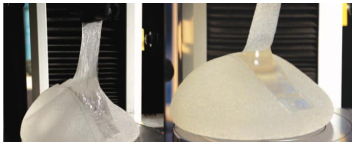
Figura 2.5: due esempi di risultati: a destra si nota una protesi che mostra una stabile integrazione tra gel e guscio, a sinistra si nota il fallimento del test dato dalla scarsa coesione tra le componenti.
