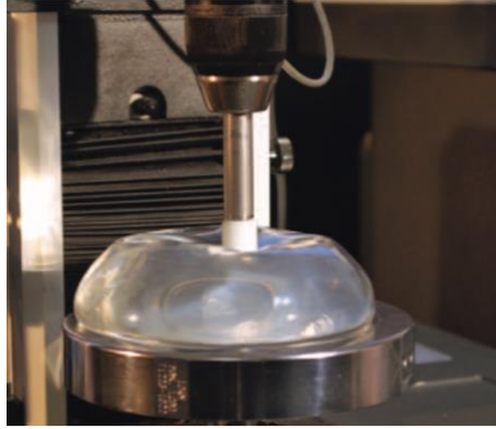
Figura 2.4: apparato per la frattura in compressione in cui si evidenziano un piede penetrometrico e una piastra di compressione.
