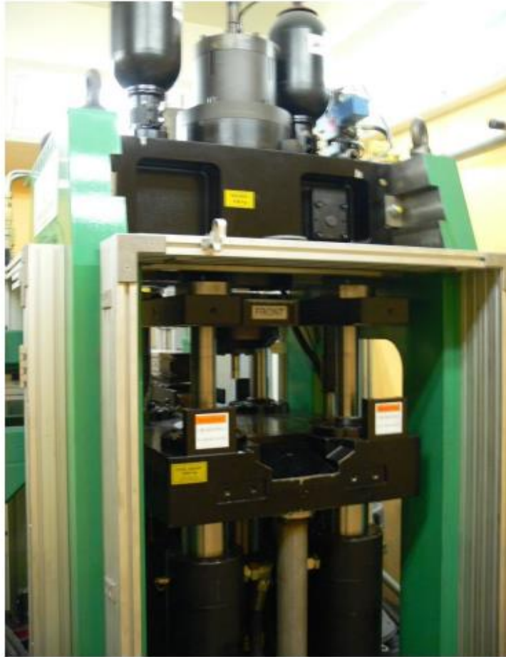
Figura 3.27 Parte superiore della pressa HVC in cui si distingue anche l'impianto idraulico che la alimenta
