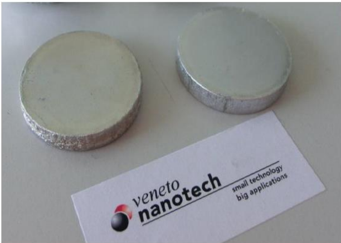
Figura 3.33 Verdi prodotti con tecnica HVC a partire da una miscela di polveri di Al_12Si , TiH_2 , Mg
