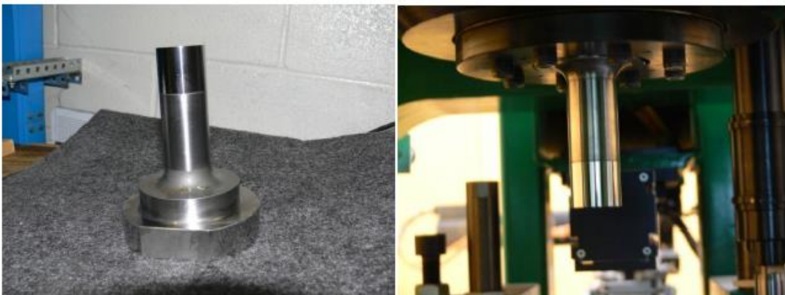
Figura 3.26 Punzone superiore della pressa HVC prima di esser montato (a sx) e dopo il montaggio (a dx)
