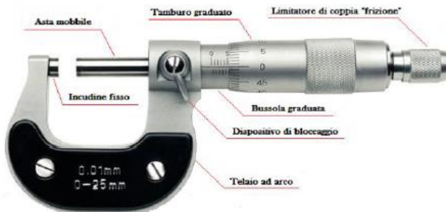
Figura 3.32 Micrometro utilizzato per rilevare lo spessore dei verdi
