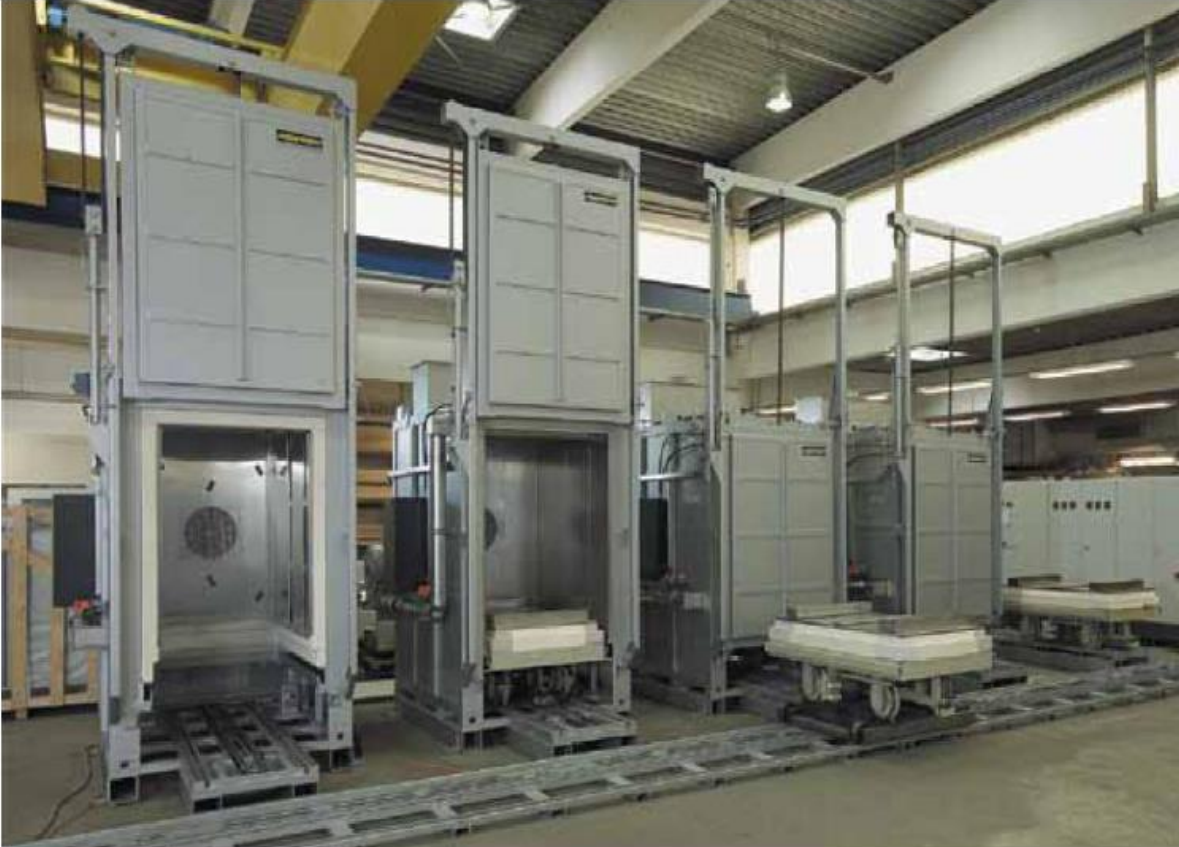
Figura 3.34 Forno Nabertherm W7500/85°C a carro presente nel centro MUSP di Piacenza
