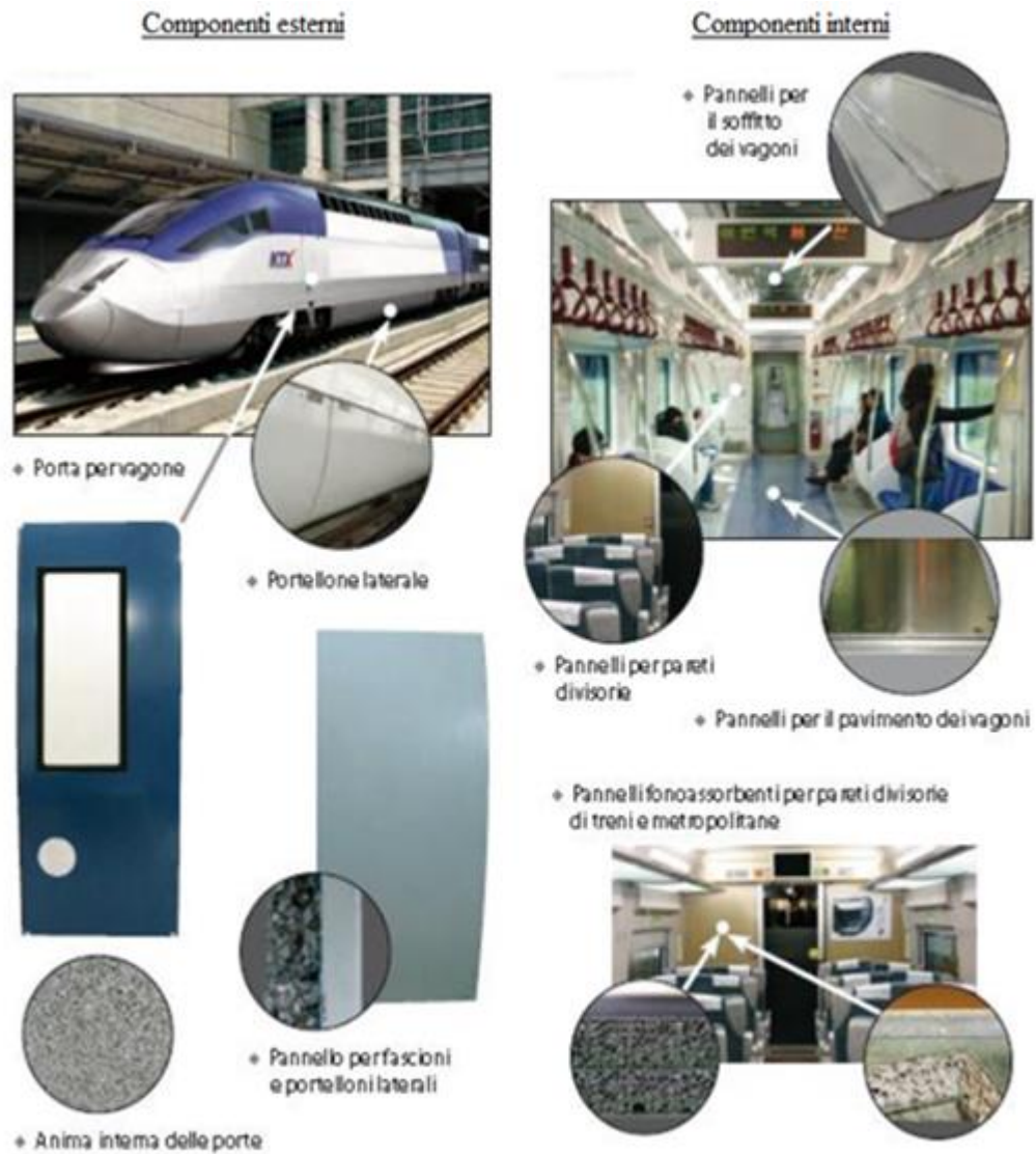
Fig. 2.45 Applicazioni delle schiume metalliche nel settore ferroviario e metropolitano
