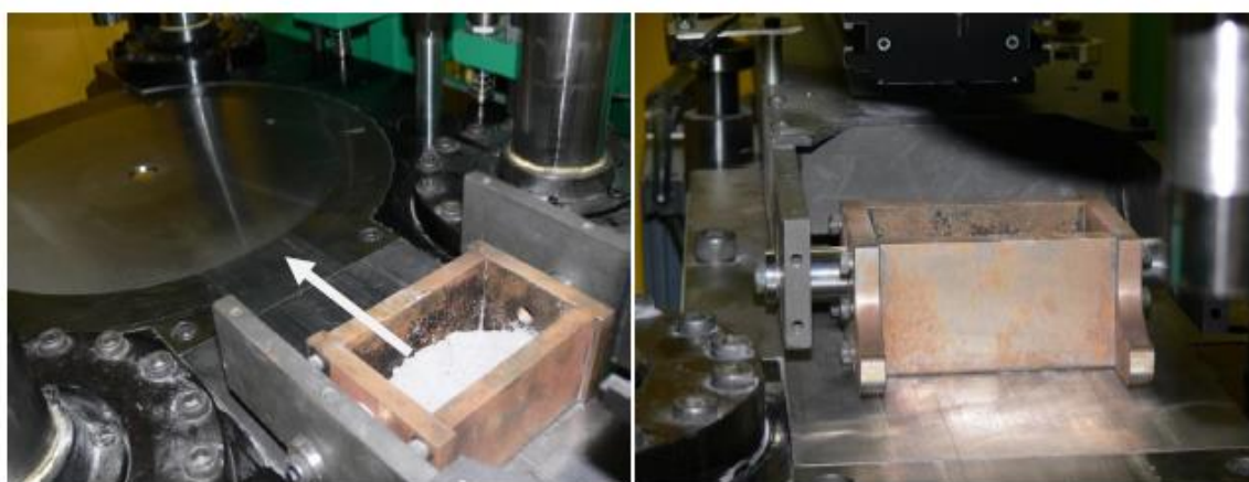
Figura 3.25 Vaschetta di alimentazione della pressa HVC vista da due prospettive diverse
