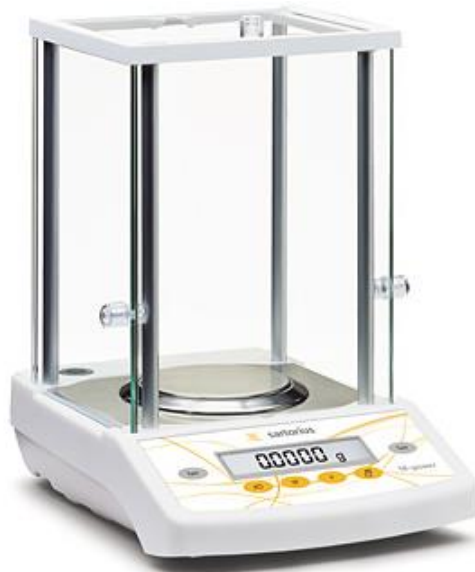
Figura 3.31 Bilancia di precisione utilizzata per rilevare il peso dei verdi
