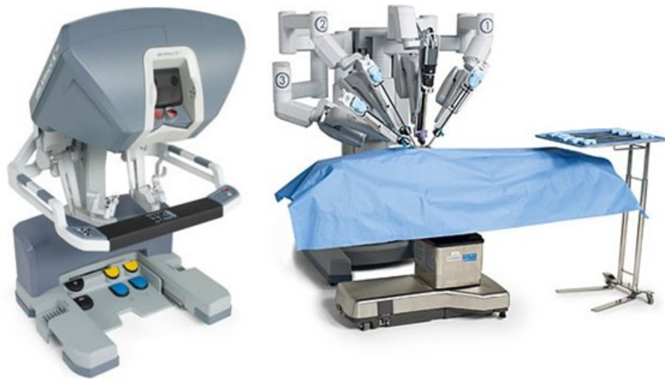
Figura 3.4: Sistema chirurgico da Vinci ® ; a sinistra la postazione per il chirurgo, a destra il dispositivo [19] .
