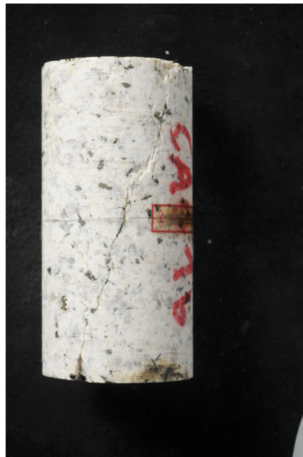
Figura 3.22: il campione CAO1B dopo la prova di resistenza a compressione triassiale. È evidente la presenza di una frattura inclinata di circa 60^\circ , in accordo con il criterio di rottura di Mohr-Coulomb.
