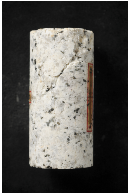
Figura 3.21: il campione CAO1A dopo la prova di resistenza a compressione triassiale. È evidente la presenza di una frattura inclinata di circa 45^\circ .
