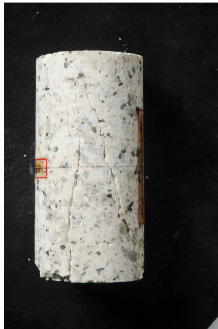
Figura 3.23: il campione CAO1C dopo la prova di resistenza a compressione triassiale. È evidente la presenza di una frattura inclinata di circa 60^\circ e di una pressoché verticale.
