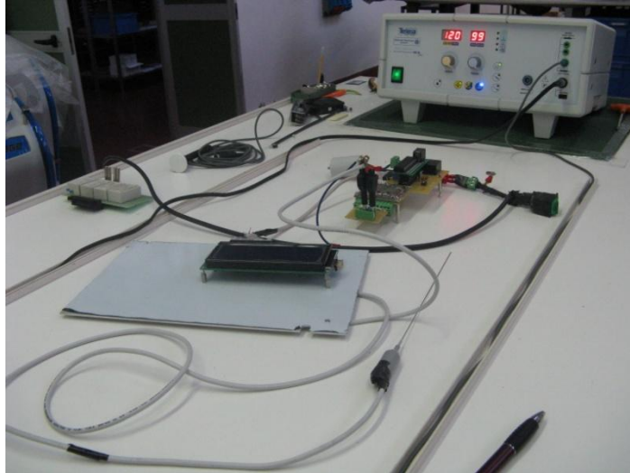
Figura 3.34. Banco di prova per i test di disturbo.
