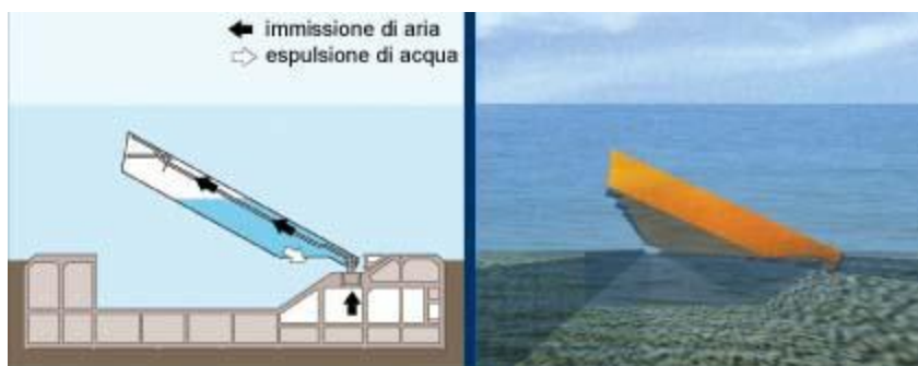
Figura 5.1 Fase di sollevamento delle paratoie
