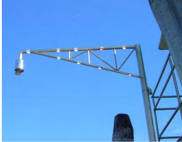
Figura 2.3 Ondametro ad ultrasuoni montato all'esterno della stazione di Murano (ISPRA – Rete Mareografica della Laguna di Venezia e del litorale Nord-Adriatico).
