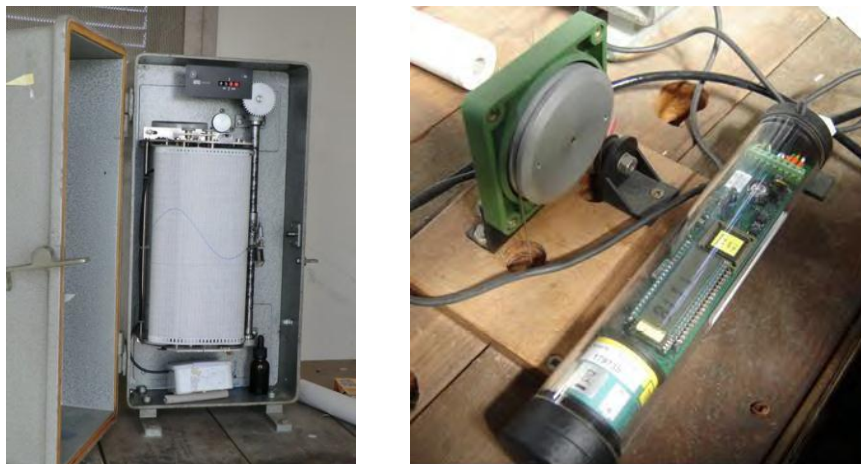
Figura 2.2 Mareografi in uso presso ISPRA - Rete Mareografica della Laguna di Venezia e del litorale Nord-Adriatico. A sinistra: mareografo meccanico posto nella stazione mareografica di Val Grande. A destra: mareografo elettronico all'interno della stazione mareografica di Punta della Salute.
