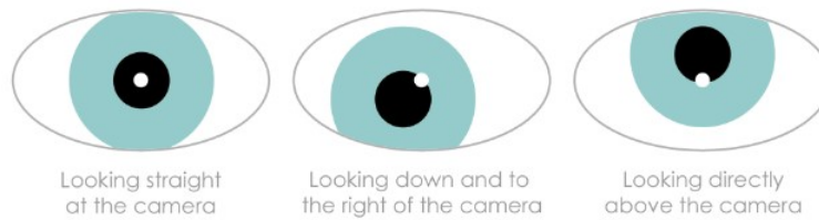
Figura 4.10: Schema di funzionamento PCCR (Fonte: Brain Support)
