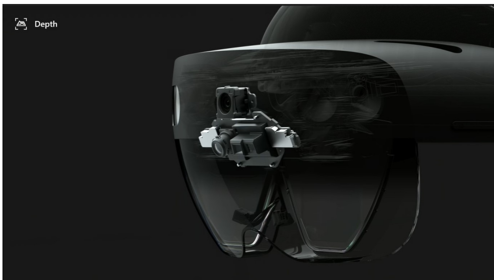
Figura 4.12: Posizionamento del sensore di profondità (Fonte: Microsoft)
