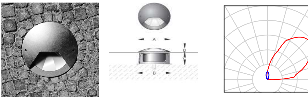
Figura 17: BEGA 8720; immagine, dimensioni e curva fotometrica
