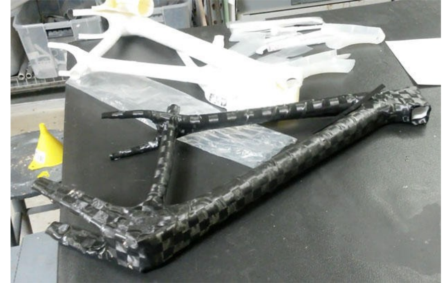
Il telaio fuori dallo stampo, pronto per essere unito con chainstays e seatstays. [5]
