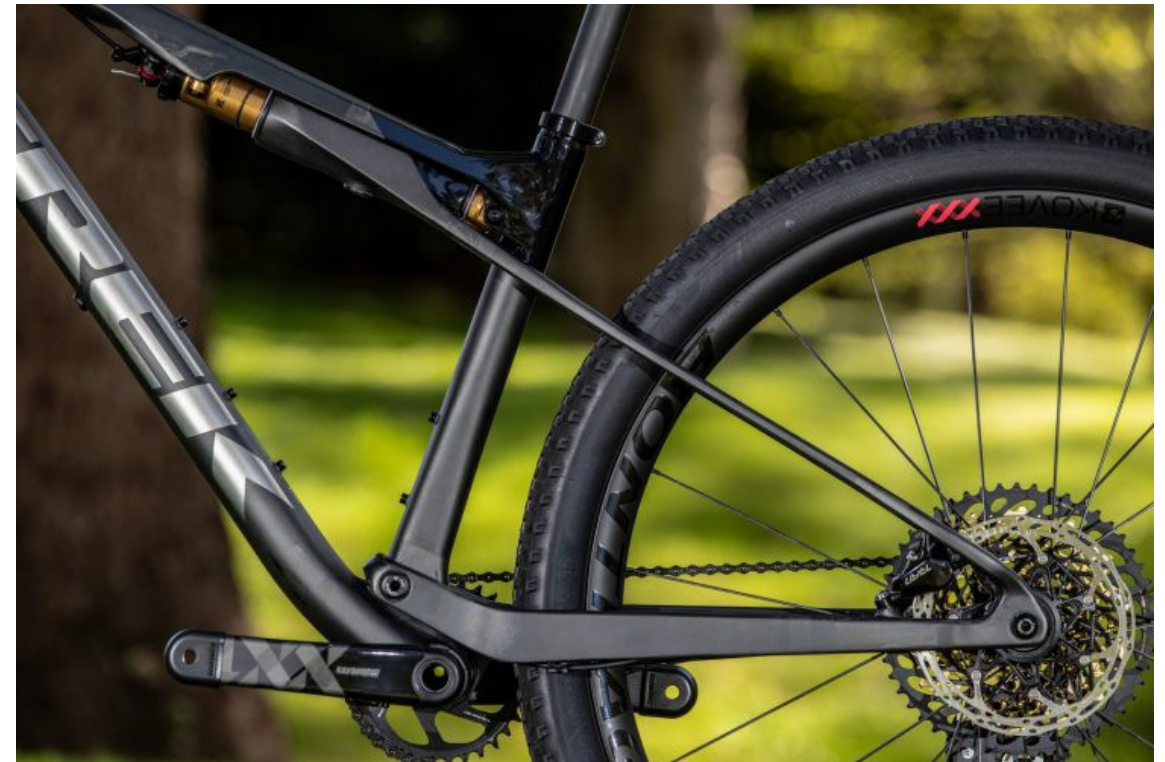
Il flex pivot della Trek SuperCaliber, la prima bici ad implementare questa novità [13]
