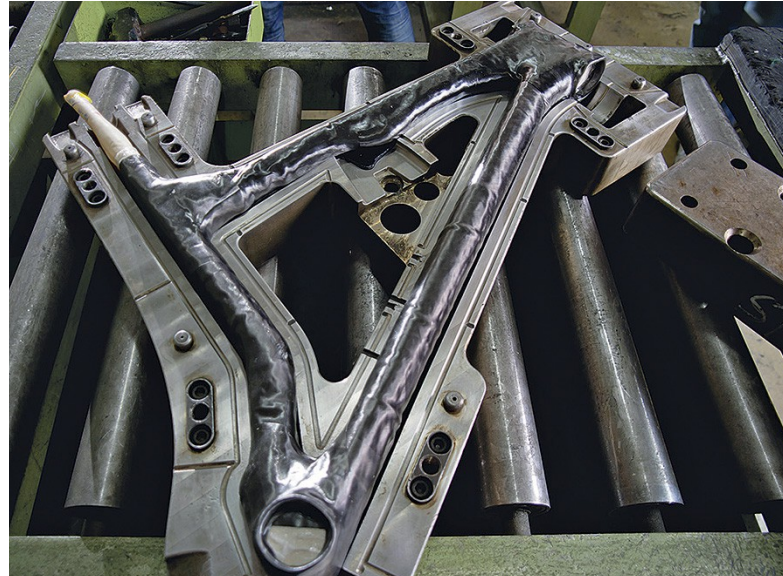
Lo stampo con all'interno il telaio formato. [4]
