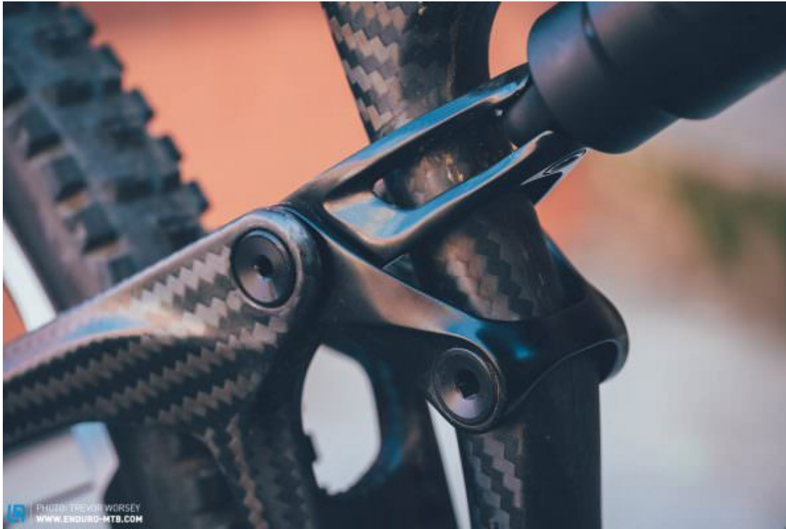
Linkaggio della sospensione posteriore di un telaio in carbonio [12]
