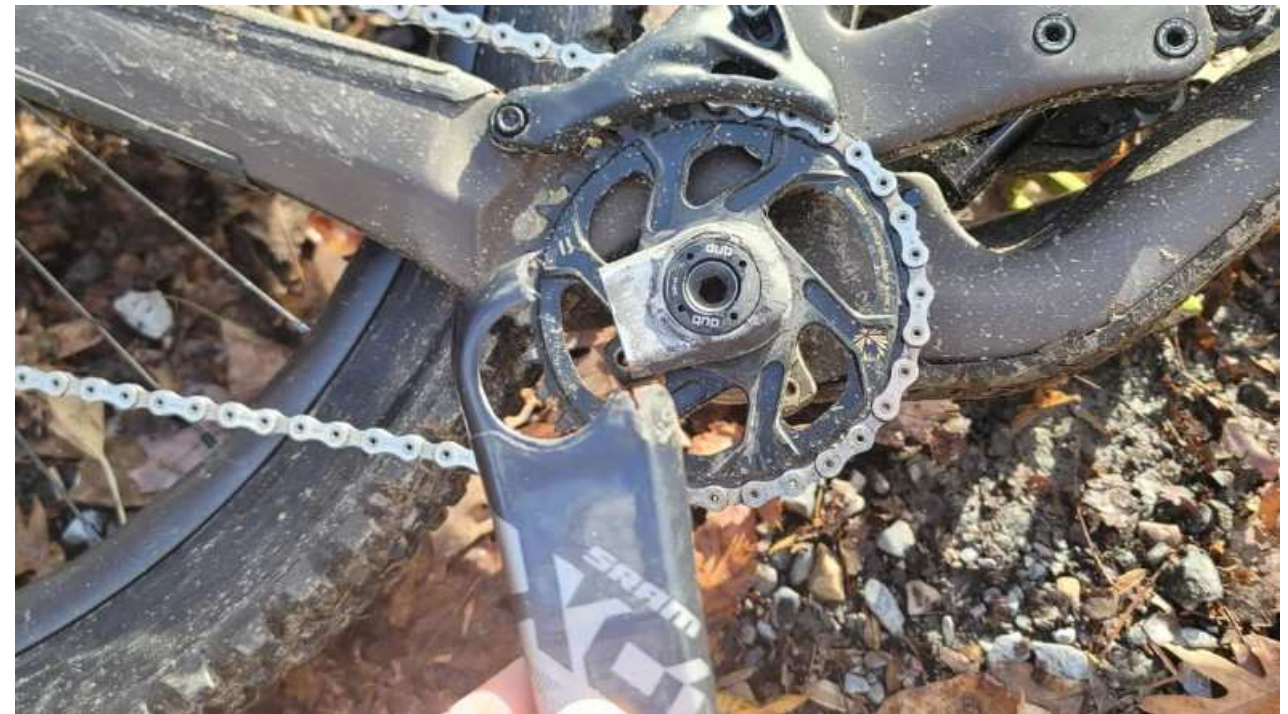
Fallimento delle pedivelle nella zona di giunzione. [21]
