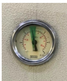
Figura 5.7: Manometro con indicatore verde per indicare il range di pressione ottimale
