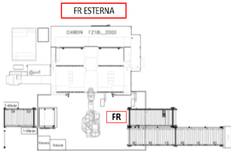
Figura 4.4: Isola FR, da sinistra a destra si possono vedere la rulliera di carico che termina con il sistema di visione; al centro il robot e di fronte la foratrice; la rulliera di avanzamento verso la postazione dell'operatore di fine linea e una rulliera di scarico.
