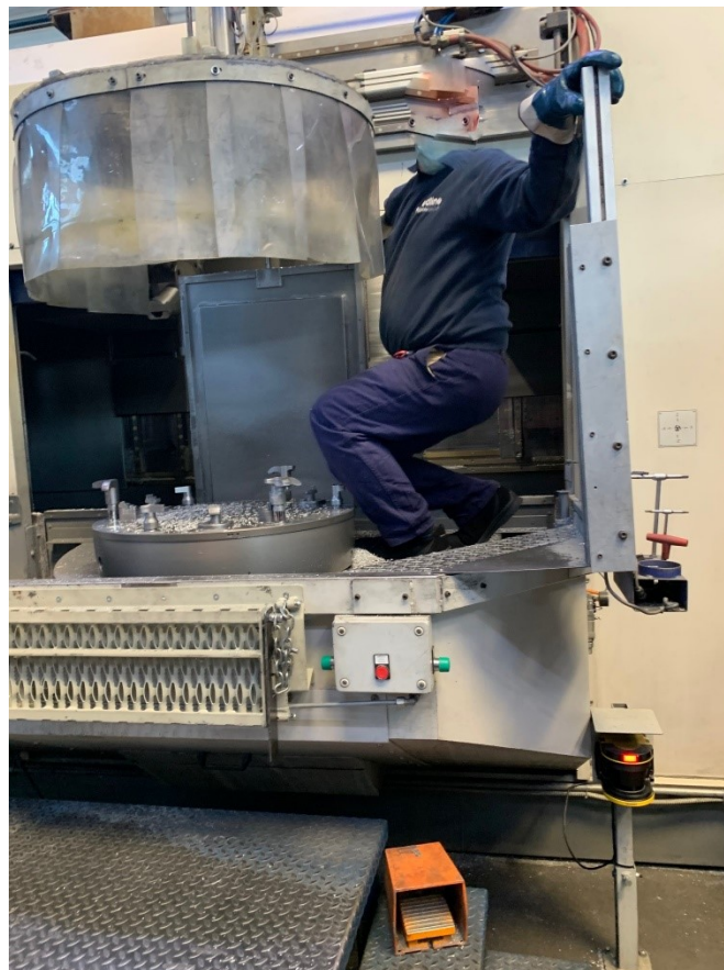
Figura 5.10: Operatore durante la pulizia del filtro interno alla macchina in una situazione di pericolo
