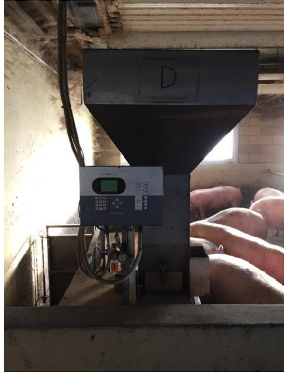
**Figura 3.** Stazione di autoalimentazione (*Compident Pig – MLP; SchauerAgrotonicGmbH, Prambachkirchen, Austria*)
