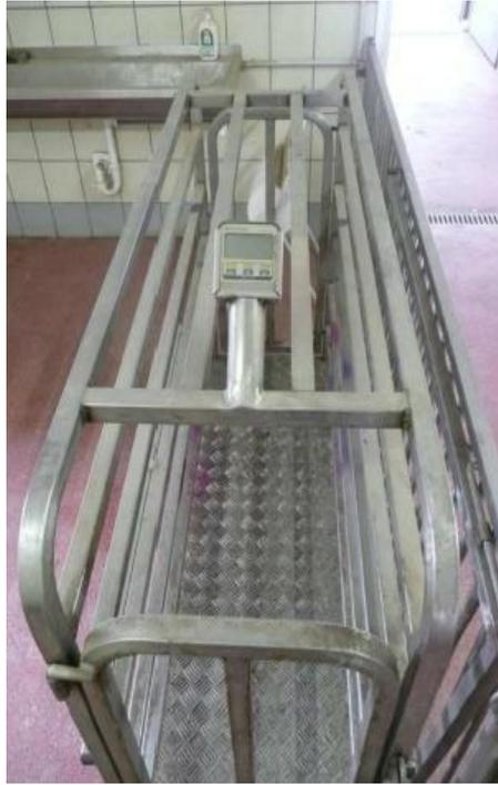
**Figura 11.** Bilancia elettronica della Gong portatile
