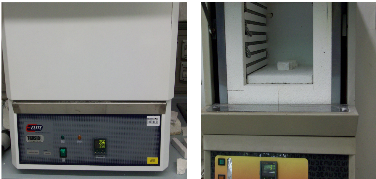
Figure 3.6 e 3.7: Forni modello Elite (sx) e Carbolite (dx) utilizzati per i trattamenti termici
