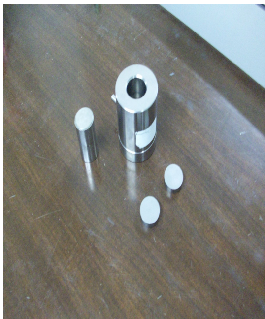
Figure 3.4 e 3.5: Stampo e pistone per la formatura dei campioni (sx) e pressa idraulica per la formatura (dx)
