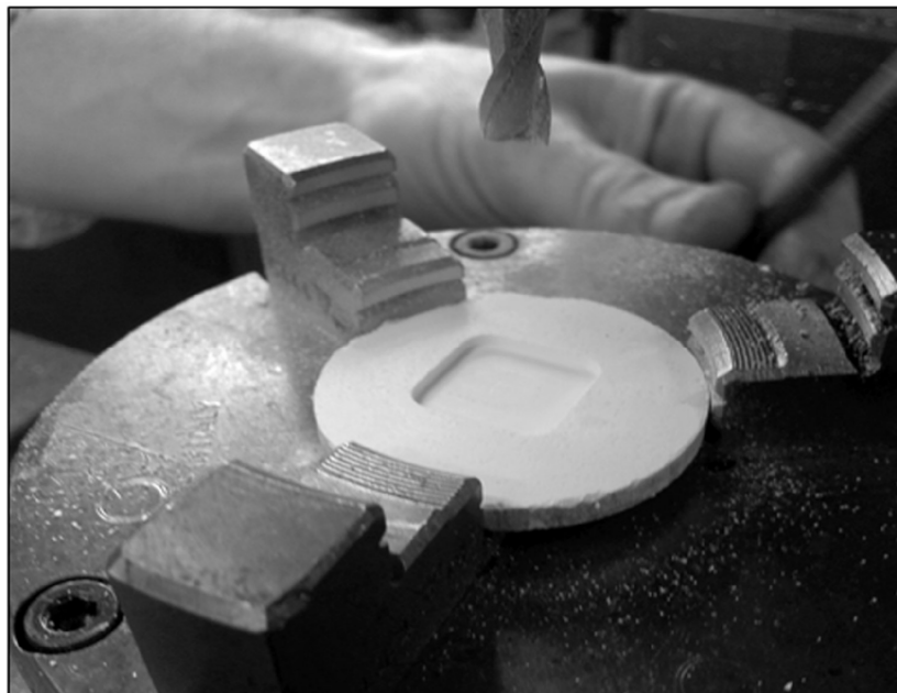
Figura 1.11: Dischetto di forsterite ottenuto per warm pressing
