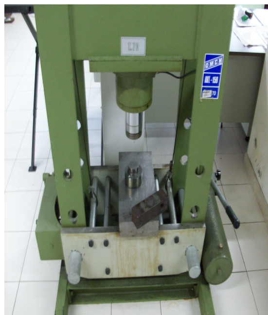
Figure 3.4 e 3.5: Stampo e pistone per la formatura dei campioni (sx) e pressa idraulica per la formatura (dx)
