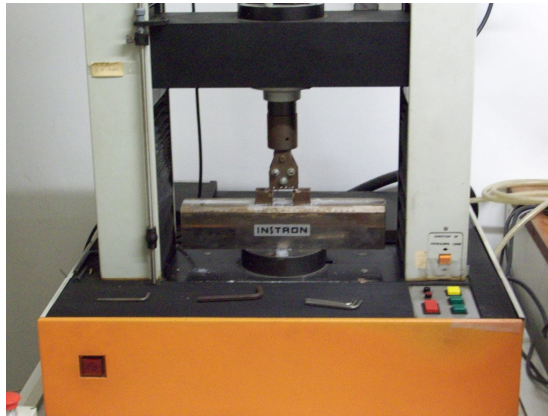
Figura 4.7: Macchina Instron UTM1121 impiegata nelle prove di flessione
