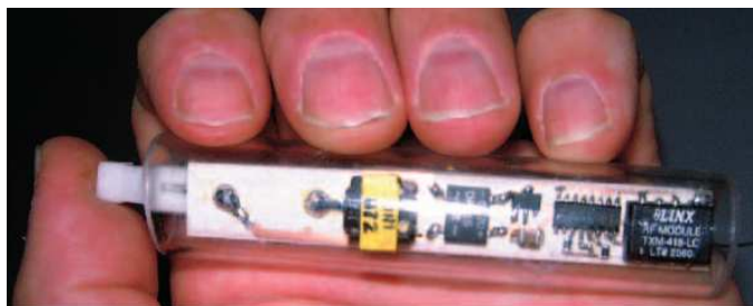
Figura 5.2: Telecomando wireless autoalimentato dalla pressione del pulsante.
