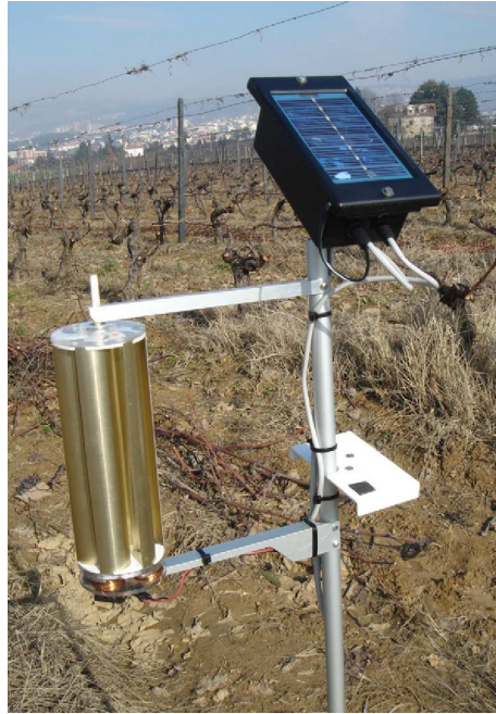
Figura 5.3: Nodo di misura in una rete wireless di monitoraggio delle colture [18]. Si notano generatore eolico e pannello solare.
