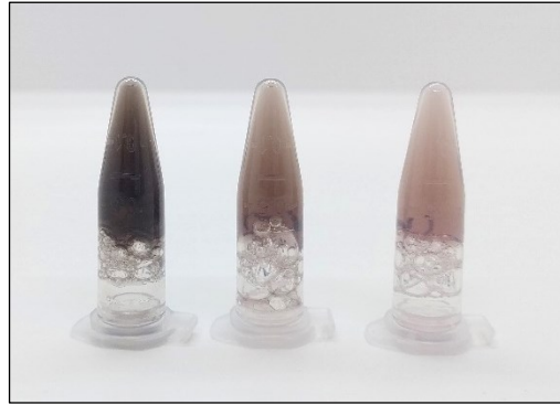
Figura 2.18 Idrogel di nanocellulosa carbossilata con MWCNT-S1 (da sinistra) 0.1wt%, 0.2wt% e 0.5wt%.
