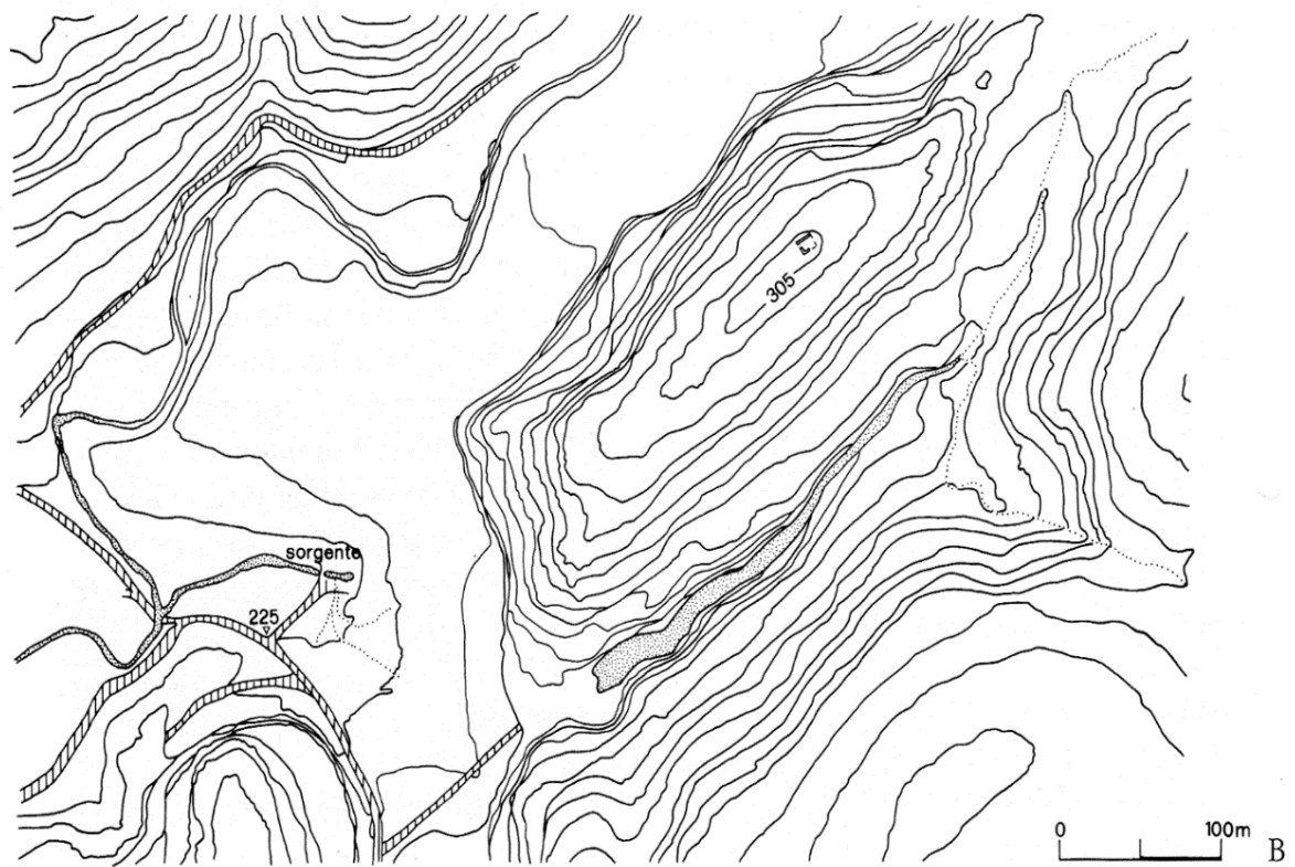
Fig. 3. Rilievo fotogrammetrico che mostra i cambiamenti morfologici della rupe, causati dai lavori di cava. A. Situazione originaria prima della cava; B. Situazione al 1980 (da Sorgenti Nova 1995, fig. 7).
