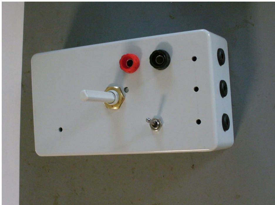
Foto 3: contenitore forato con trapano a colonna complete di interruttori e passacavi.
