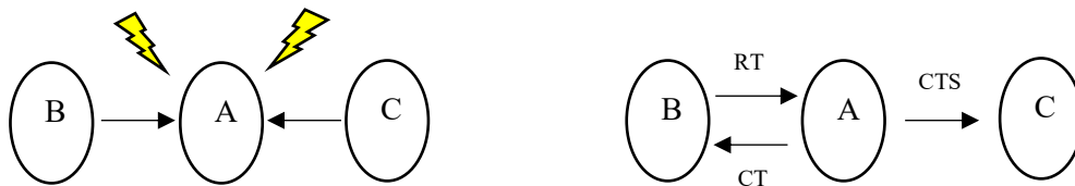
Fig. 2.2 - Il primo schema rappresenta la collisione tra i frame della STA C e B mentre il secondo schema rappresenta il meccanismo RTS-CTS.
