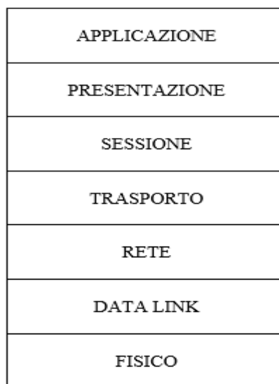
Fig. A.1 - Schema a blocchi dei livelli del modello ISO/OSI.
