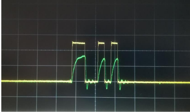
Fig. 6.13 - Trasmissione di un byte sulla linea MOSI in uscita del PSoc (grafico giallo) e in ingresso di ATWINC1500 (grafico verde).
