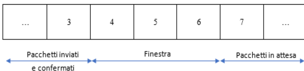
Fig 4.1 - Meccanismo della finestra lato trasmettitore
