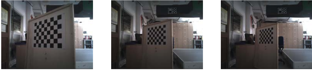
Sequenze di foto con la scacchiera ruotata rispetto all'asse verticale della camera
