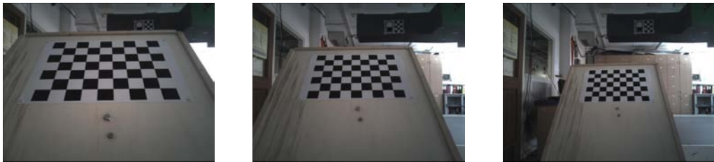
Sequenze di foto con la scacchiera ruotata rispetto all'asse orizzontale della camera
