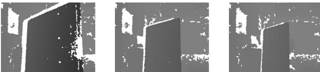
Sequenze di foto con la scacchiera ruotata rispetto all'asse verticale della camera, immagine di profondità (depth image)
