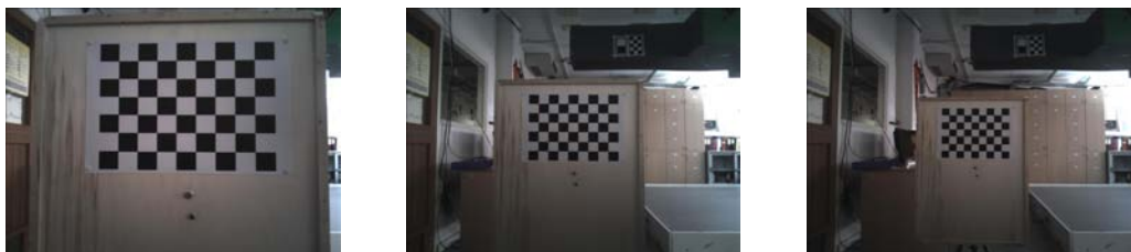
Sequenze di foto con la scacchiera parallela alla camera
