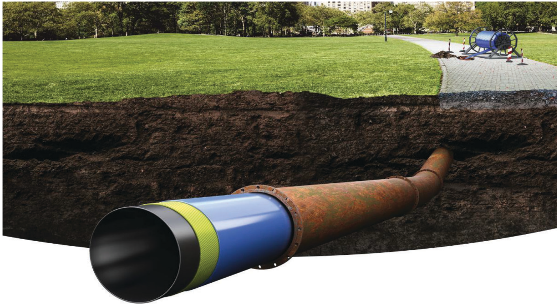
Figura 1.8: Teniche di riparazione rete acquedottistica no-dig.
