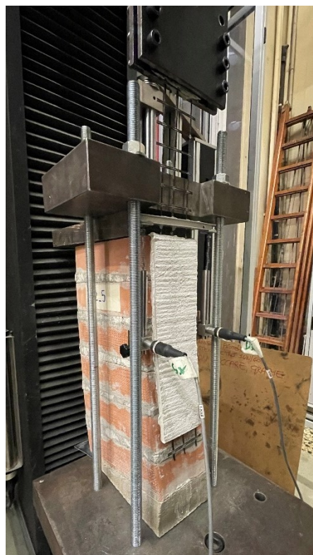
Figura 13: Set-up prova di taglio diretto per un generico campione a substrato curvilineo.
