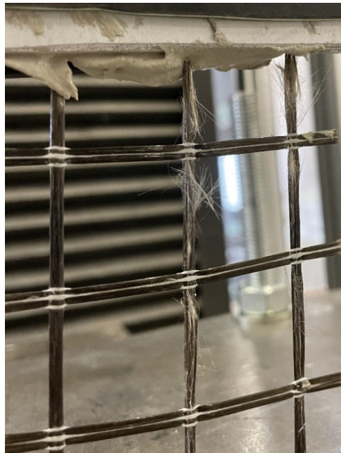
Figura 16: Esempio di modalità di rottura a trazione della fibra per il campione R \infty _2_280_80.
