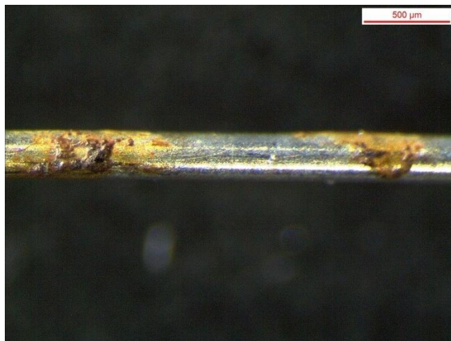
Figura 6.7 particolare visto a 25x del campione di corda di violino dopo 1440 min di esposizione alla nebbia salina
