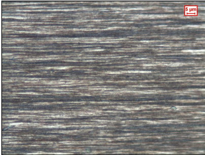
Figura 4.10 Micrografia ottica a 500x della sezione longitudinale della corda di violino Lenzner dopo attacco chimico
