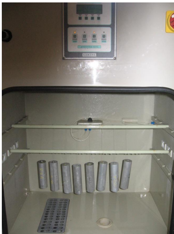
Figura 6.1 Camera per la nebbia salina e disposizione dei provini
