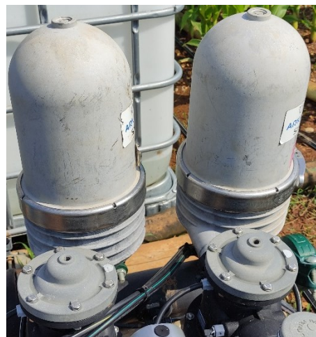
Figura 3.5: Esempio di filtro a dischi
