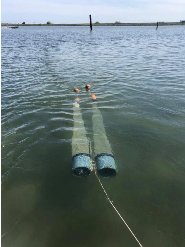
Figura 3 - Bongo-net utilizzato per effettuare i campionamenti
