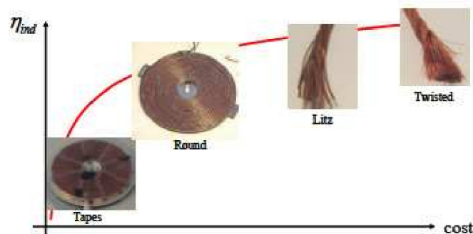
Figura 6.2: Tipologia di conduttore
