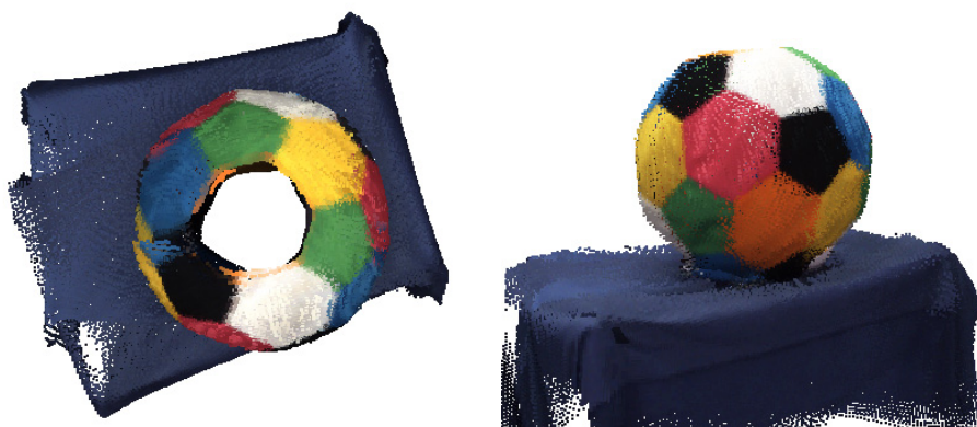
Fig. 5.13: Vista frontale e dall'alto della ricostruzione di un pallone. La ricostruzione a 360°ha coinvolto 45 frame.
