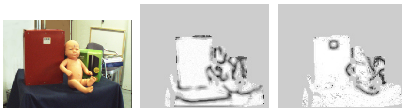
Fig. 5.7: Da sinistra a destra: (a) Immagine di un insieme di oggetti (b) immagine della rilevanza geometrica (c) rilevanza del colore
