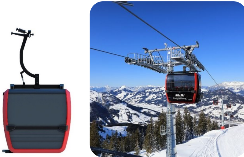
2.1 Esempio di una cabina e di un impianto monofune.
