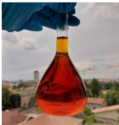
Figura 76: Soluzione madre di iodio impiegata nella calibrazione.
