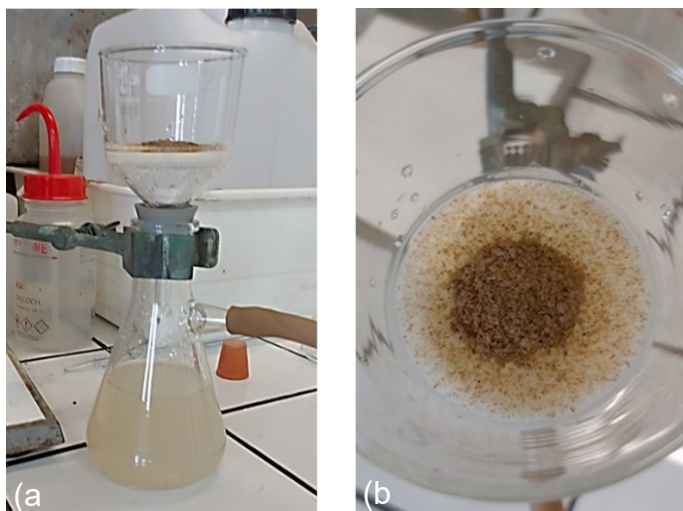
Figura 41: (a) Acque di lavaggio recuperate dopo la filtrazione e lavaggi; (b) Solido ottenuto a fine metallazione.
