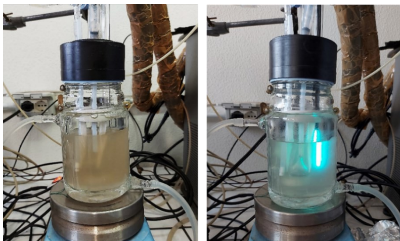
Figura 68: Reattore ad inizio, prima di accendere la lampada UV (a sinistra) e a fine (a destra) test catalitico svolto in presenza di Pd/pDVB-SO 3 H
