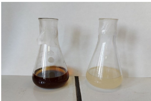
Figura 80: Colore dello stesso campione dopo il periodo di raffreddamento e prima della filtrazione condotto all'aria (a sinistra) ed in atmosfera inerte (a destra).
