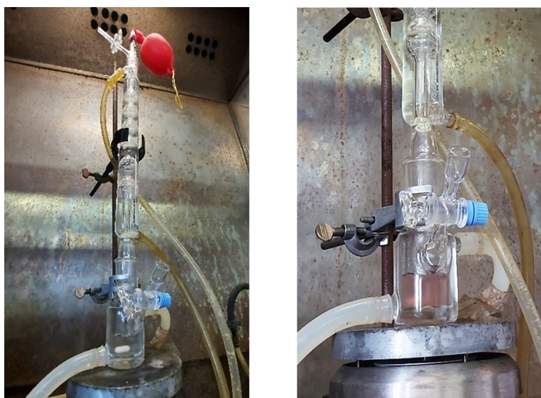
Figura 79: Set-up sperimentale per la preparazione dei campioni per le titolazioni iodometriche (a sinistra); particolare sul reattore (a destra).
