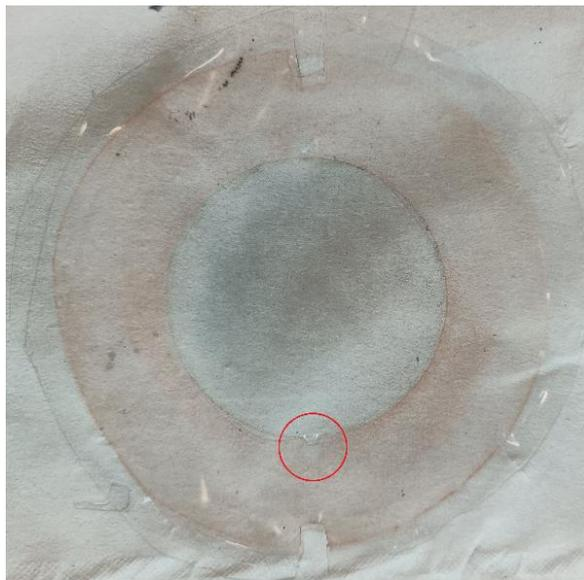
**Figura 4.21** Condizioni della membrana secca una volta ultimato il test di pressione. Nel cerchio in rosso è possibile osservare la presenza di una rottura.
