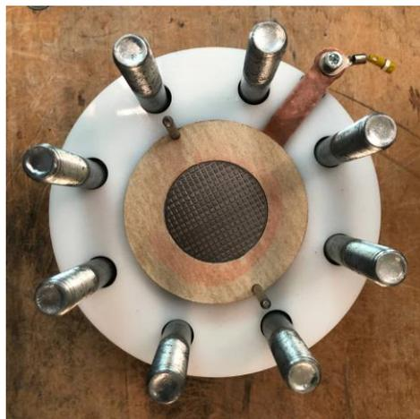
**Figura 3.13** Guarnizione posta al di sopra di un BP all'interno della cella PEM.
