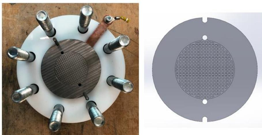
*Figura 3.12 Sx) Fotografia del BP in Ti alloggiato all'interno della cella PEM; Dx) Disegno dei BP in cui è possibile vedere la trama del flow field.*
