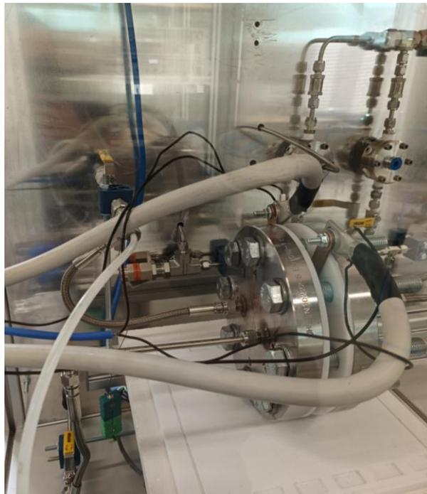
**Figura 3.24** Fotografia della cella assemblata e collegata all'impianto di elettrolisi. I contatti elettrici della power unit sono collegati agli appositi fori dei collettori di corrente (CC). In primo piano la parte anodica in cui sono collegati i tubi per l'ingresso dell'acqua e per la fuoriuscita della miscela  $H_2O/O_2$ . Dalla parte opposta (non visibile) la parte catodica alla quale è collegato il tubo per la fuoriuscita della miscela  $H_2O/H_2$ .
