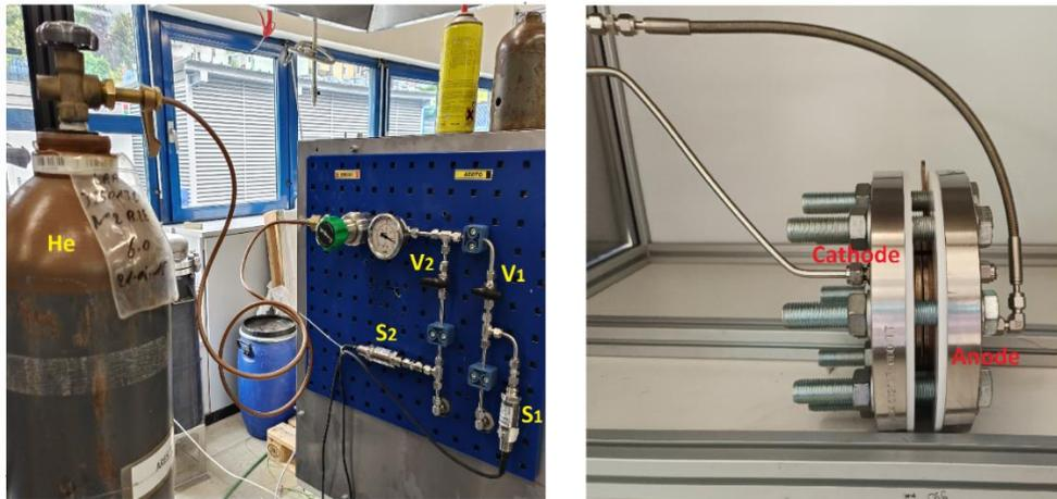
*Figura 3.22 Setup utilizzato per le misure di tenuta con He. A sinistra  $V_1$  indica la valvola di controllo del lato catodico,  $V_2$  quella del lato anodico.  $S_1$  e  $S_2$  sono i sensori di pressione che misurano quest'ultima al lato catodico e anodico, rispettivamente. A destra è possibile osservare la cella PEM collegata alla linea.*
