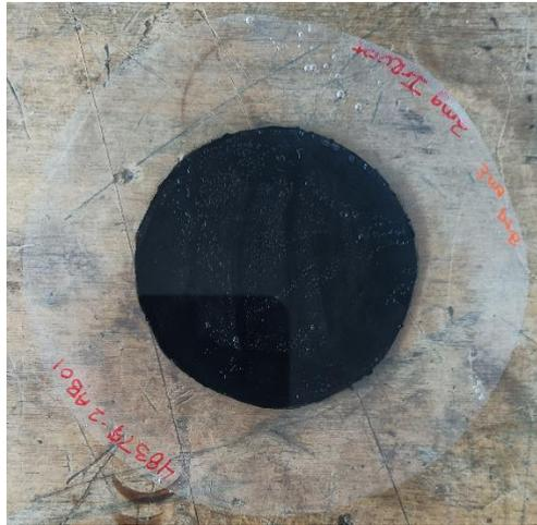
**Figura 3.7** MEA in Tion 5-W della Fuel Cell Store sulla quale è possibile notare la presenza della CL anodico IrRuO<sub>x</sub> 3mg. Sul lato opposto della membrana è depositato il PtB 3 mg.
