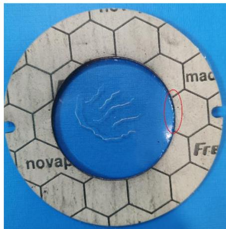
**Figura 4.19** Condizioni della membrana secca una volta ultimato il test di pressione. Nella zona centrale si notano alcune crepe mentre nel cerchio in rosso è evidenziata la zona in cui si è verificato lo strappo.
