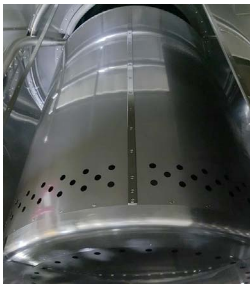
Figura 5.1: Schermo a 600 kV utilizzato per i test del HVB. Le lamiere che fanno da parete presentano pochi fori; questo perché, non avendo un flusso di gas dall'interno, la conduttanza richiesta è ridotta
