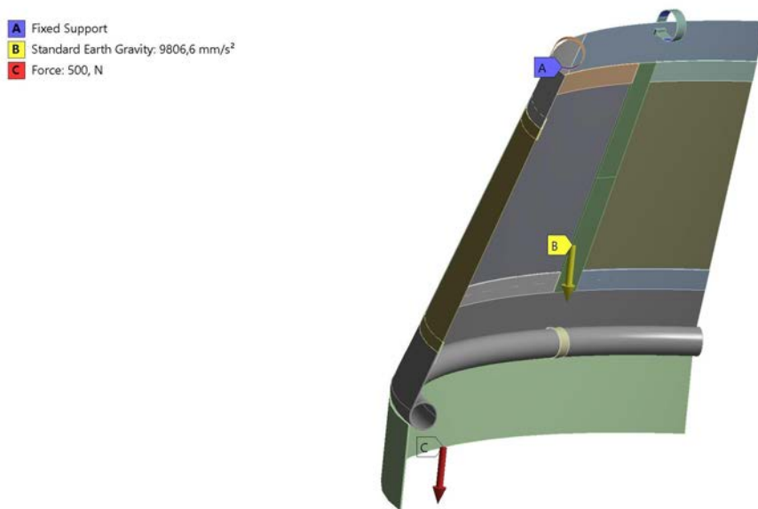
Figura 5.9: Modello ridotto in ANSYS con carichi e vincoli. Il cilindro inferiore in realtà è stato modellato con una lunghezza maggiore per evitare problemi localizzati. Nell'immagine è corto per permettere la chiara visualizzazione dei carichi e vincoli.
