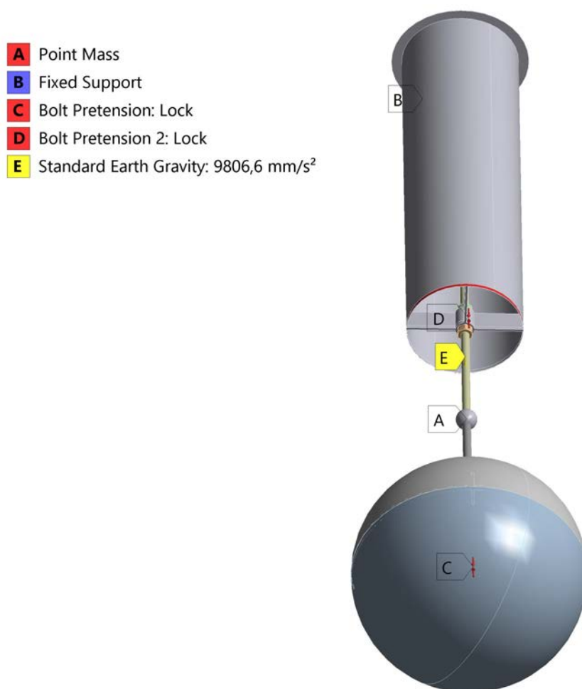
Figura 3.5: Modello con vite M39 con indicati i carichi e vincoli applicati
