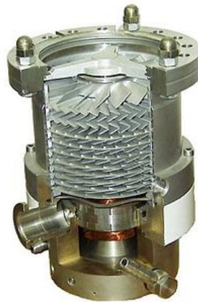
Figura 2.28 - Sezione longitudinale di una pompa turbomolecolare
