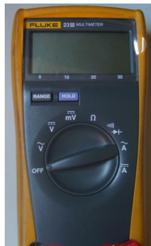
Figura 6.4 - Multimetro Fluke 23111 di laboratorio del sistema di misura di resistenza
