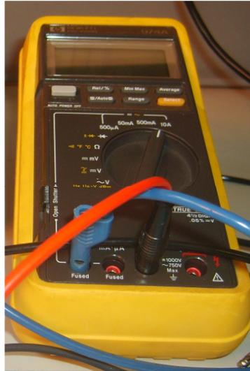
Figura 6.3 - Tester HP 974A di laboratorio del sistema di misura di resistenza
