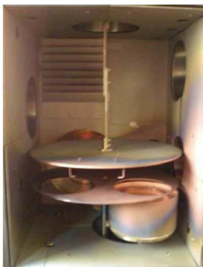
Figura 5.3 - Vista della sezione longitudinale camera di deposizione
