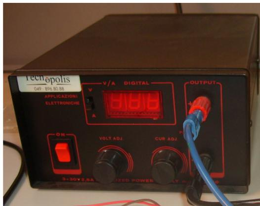
Figura 6.1 - Generatore di corrente (Tecnopolis) di laboratorio del sistema di misura di resistenza
